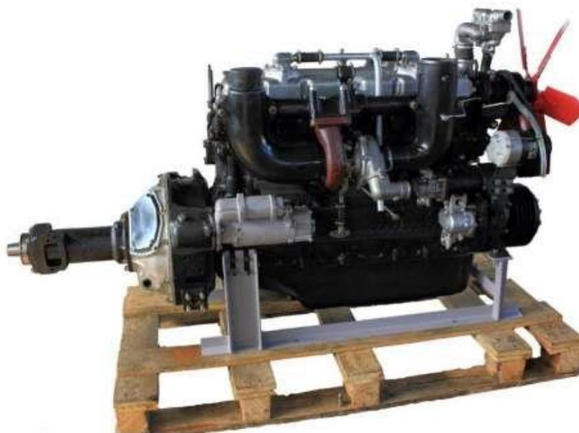
Рисунок 2 – Тракторный дизельный двигателя СМД-31а
