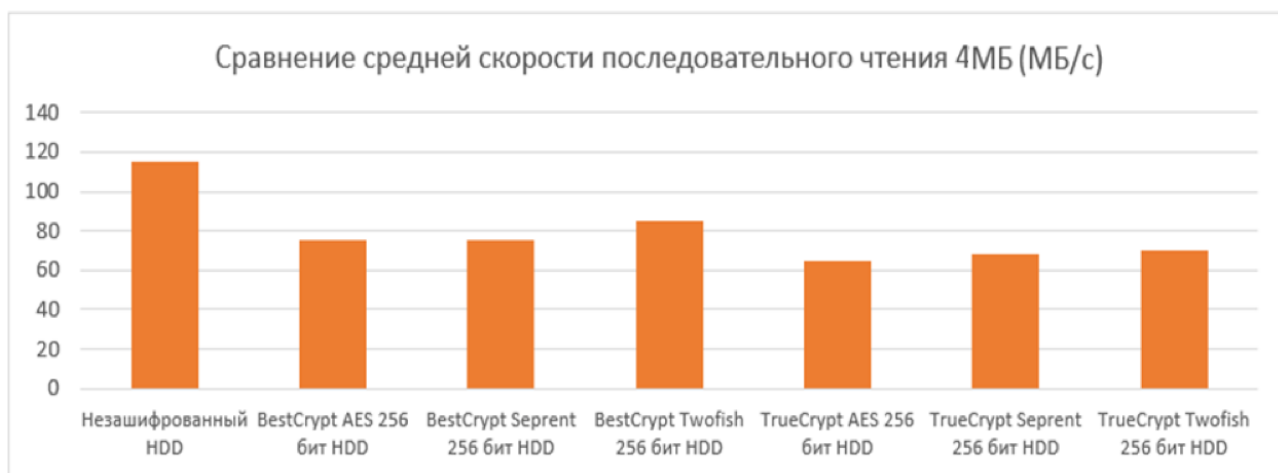
Рисунок 14 - Сравнение средней скорости последовательного чтения SSHD 4 МБ после применения AES, Serpent и Twofish 256 бит с использованием BestCrypt и TrueCrypt
