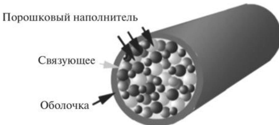
Рисунок 6 – Строение шнурового материала для напыления
