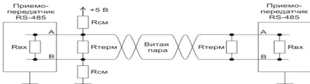
Рисунок 54 –Защитное смещение RS-485
