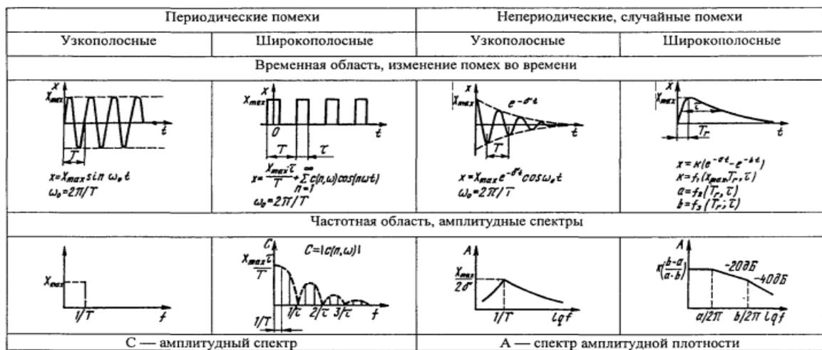
Рисунок 6 –Классификация ЭМП по частотному спектру и периоду
