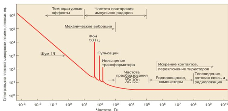
Рисунок 7 –Спектральная плотность мощности электромагнитной помехи
