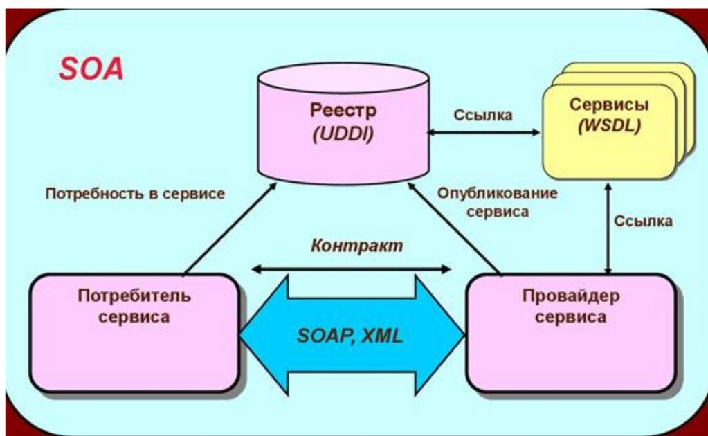
Рисунок 11- Типовая схема архитектуры SOA
