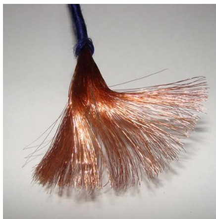
Рисунок - 2.8 Внешний вид провода литцендрат
