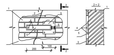
Рис. 32. Металлический маяк: 1 — конструкция с развивающейся трещиной; 2 — трещина; 3 — штукатурка; 4 — гвозди; 5 — металлический маяк (из кровельной стали); 6 — риски через 1 мм
