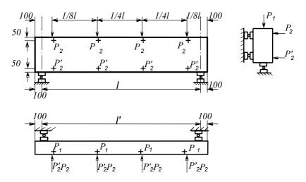
Рис. 5. Схема приложения нагрузок при испытании стеновых панелей
