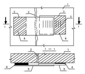
Рис. 33. Маяк из плексигласа или стекла: I — строительная конструкция; 2 — трещина; 3 — плексигласовые или стеклянные пластинки, скользящие одна по другой при раскрытии трещины; 4 — оклеечная мастика; 5 — риски на пластинах, по изменению расстояния между которыми определяют величину раскрытия трещин
