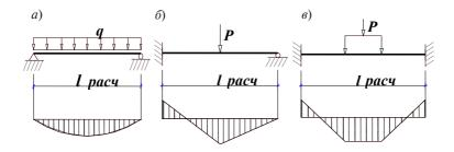
Рис. 1. Схемы опирания и распределения растягивающих напряжений: a — свободное опирание с равномерно распределенной нагрузкой;  $\delta$  — защемление на одной опоре с загружением сосредоточенной нагрузкой;  $\epsilon$  — защемление на двух опорах с передачей на конструкцию двух сосредоточенных сил
