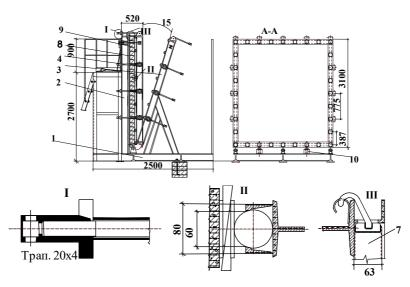
Рис. 10. Стенд для испытаний плоских плит равномерно распределенной нагрузкой
