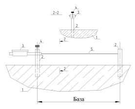
Рис. 25. Схема установки индикатора часового типа для измерения продольных деформаций: I — конструкция, деформации которой измеряются; 2 — опоры, заделанные в конструкцию или приклеенные к поверхности; 3 — индикатор часового типа, закрепленный на опоре; 4 — зажимный винт; 5 — удлинитель
