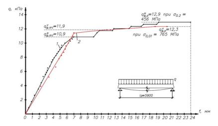
Рис. В2. Прогиб в середине пролета плит: I — с рабочей арматурой класса A400, 2 — то же класса A600;  $q_{\rm \phi,p}$  — фактическая разрушающая нагрузка при  $\sigma_{\rm 0,01}$  и  $\sigma_{\rm 0,2}$ ;  $q_{\rm \phi,crc}$  — фактическая нагрузка образования трещин
