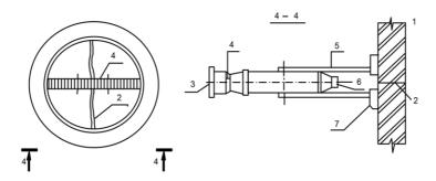
Рис. 36. Отсчетный микроскоп МПБ-2: 1- строительная конструкция; 2- трещина; 3- окуляр; 4- шкала; 5- штатив; 6- лупа; 7- основание
