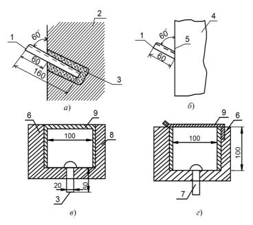
Рис. 42. Нивелирные марки стенные (a и  $\delta$ ) и в фундаментных плитах (a и e): a — в каменных стенах;  $\delta$  — на стальных колоннах; e — с ввинчивающейся крышкой; e — с откидной крышкой; e — уголок; e — стена из кирпича; e — цементный раствор; e — металлическая колонна; e — место сварки; e — бетон плиты; e — марка; e — защитный короб; e — крышка
