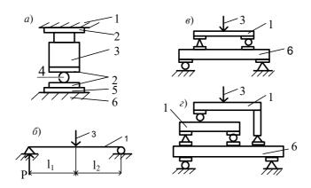
Рис. 12. Передача сосредоточенных усилий на конструкцию: a — передача усилия непосредственно от домкрата;  $\delta$  — расчетная схема траверсы;  $\epsilon$  — передача усилия на конструкцию в двух точках;  $\epsilon$  — то же, в трех точках;  $\epsilon$  — траверса;  $\epsilon$  — опорная распределительная пластина;  $\epsilon$  — домкрат;  $\epsilon$  — металлический шар;  $\epsilon$  — песчаная (растворная) подушка;  $\epsilon$  — испытываемая конструкция
