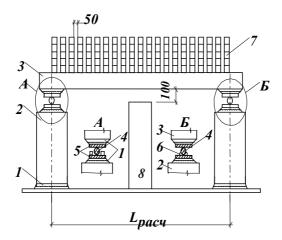
Рис. 6. Стенд для испытаний конструкций с опиранием по балочной схеме: I — выравнивающий слой раствора  $\delta = 10-20$  мм; 2 — опорный блок H = 1000-1200 мм; 3 — опытная конструкция; 4 — подвижный и неподвижный катки; 5 — нижняя и верхняя опорные металлические пластины; 6 — сварной шов; 7 — штучные грузы; 8 — страховочная опора
