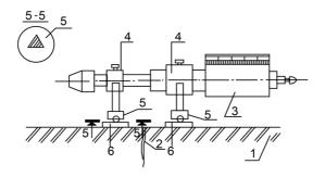
Рис. 39. Наблюдение за развитием трещины с помощью мессуры: I — строительная конструкция; 2 — трещина; 3 — индикатор часового типа; 4 — насадки, закрепленные на винтах; 5 — опорная часть насадок с треугольным углублением; 6 — пластинки с шариками, закрепленные на поверхности конструкции
