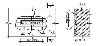
Рис. 31. Гипсовый одиночный маяк: 1 — строительная конструкция с трещиной; 2 — трещина; 3 — штукатурка; 4 — гипсовый маяк
