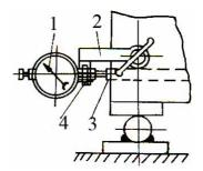
Рис. 24. Схема установки индикатора для измерения смещения арматуры: 1 — индикатор; 2 — струбцина; 3 — стержень арматуры; 4 — хомутик
