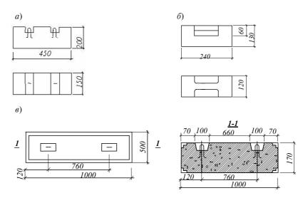
Рис. 8. Конструкции штучных грузов: a — чугунные массой 100 кг;  $\delta$  — то же, массой 20 кг; e — железобетонные, окантованные металлическим уголком, массой 200 кг
