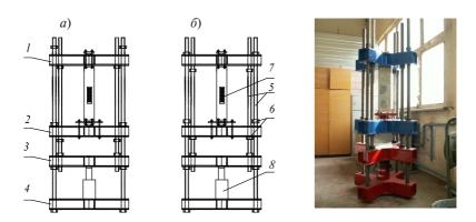
Рис. 16. Схема установки для испытания на осевое знакопеременное загружение: a — растяжение;  $\delta$  — сжатие
