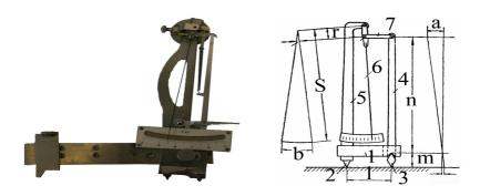
Рис. 26 Кинематическая схема механического тензометра Гугенбергера
