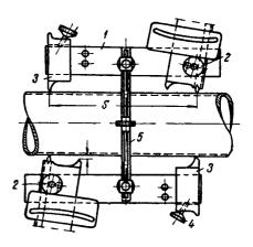
Рис. 28. Струбцинка для установки двух тензометров Гугенбергера, располагаемых с обеих сторон исследуемого элемента
