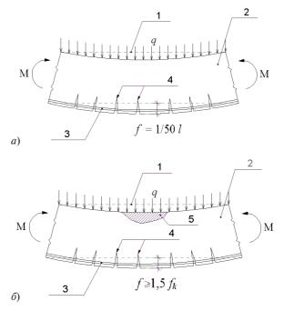
Рис. 45. Характер разрушения конструкций: a — пластический характер разрушения;  $\delta$  — хрупкий характер разрушения от раздробления бетона сжатой зоны; I — состояние конструкции до приложения нагрузки; 2 — состояние конструкции после приложения нагрузки;  $\beta$  — рабочая арматура напряжения, в которой достигли предела текучести;  $\delta$  — трещины
