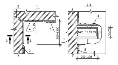
Рис. 35. Угловой гипсовый маяк: 1 — конструкция с трещиной в углу; 2 — трещина; 3 — штукатурка; 4 — гипсовый угловой маяк
