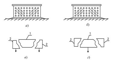
Рис. 41. Формализованные схемы возможных осадок зданий: a — при преимущественных осадках краев здания; e — при осадках средней части здания; e — упрощенные схемы перемещений; e — середина здания; e — края здания
