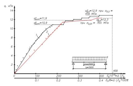
Рис. В1. Относительные деформации арматуры в плитах: I — с рабочей арматурой класса A400, 2 — то же класса A600;  $\Delta I$  — абсолютное удлинение арматуры, измеряемое прибором;  $I_s$  — база измерения деформаций
