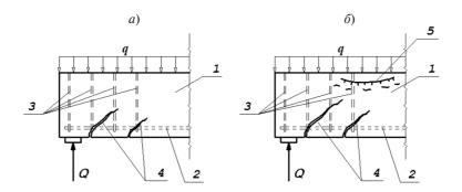
Рис. 46. Хрупкое разрушение на опоре по косым трещинам: a — раскрытие наклонных трещин свыше 1,5 мм;  $\delta$  — срез бетона над наклонными трещинами; I — изгибаемый элемент; 2 — рабочая арматура; 3 — поперечная арматура; 4 — наклонные трещины при обследованиях; 5 — отслоение лещадок в сжатой зоне сечения
