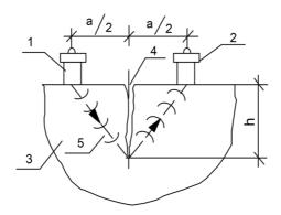
Рис. 37. Ультразвуковой импульсный метод для определения глубины трещин: 1 — излучатель; 2 — приемник; 3 — контролируемое изделие; 4 — трещина; 5 — направление прозвучивания
