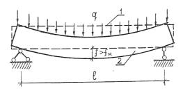
Рис. 44. Прогиб конструкции с опиранием по двум сторонам под нагрузкой: I — состояние конструкции до приложения нагрузки; 2 — состояние конструкции после приложения нагрузки
