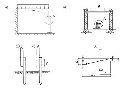
Рис. 19. Простейшие приспособления для измерения прогибов: a-c помощью двух реек;  $\delta-$  рычажное устройство со стрелкой
