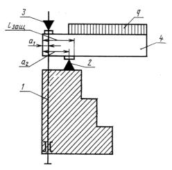
Рис. 3. Схема испытания консольной конструкции: 1- анкерная тяга; 2- нижняя опора; 3- верхняя анкерная опора; 4- испытываемая конструкция
