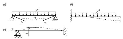
Рис. 17. Схемы прогибов  $(a, \delta)$  и выгибов (s) при действии нагрузок:  $\alpha$  и  $\beta$  — углы поворота, f — прогиб (выгиб)
