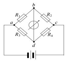
Рис. 30. Электрическая схема измерительного моста, где  $R_1,\,R_2,\,R_3,\,R_4$  — сопротивления, включенные в плечи моста
