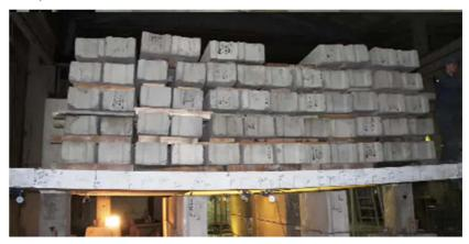
Рис. Б3. Натурные испытания фрагмента сборно-монолитного каркаса здания сотрудниками центра технических инноваций и модернизаций в строительстве «МИКС»: a — подготовка к испытаниям;  $\delta$  — нагружение безбалочного диска перекрытия штучными грузами (нагрузка составила  $10 \text{ кн/м}^2$ )
