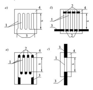
Рис. 29. Типы тензорезисторов: a — проволочный петлевой; b — проволочный беспетлевой; b — фольговый; b — полупроводниковый; b — тензочувствительные элементы; b — низкоомные перемычки; b — выводные контакты; b — подложка («основа») и наклеенный над тензорешеткой защитный слой тонкой бумаги; b — база тензорезистора
