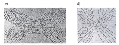
Рис. 11. Схемы развития трещин на нижней поверхности плиты от равномерно распределенной нагрузки с соотношением сторон 1:2 (a) и 1:1 ( $\delta$ )
