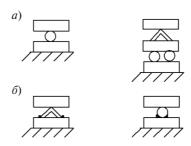
Рис. 2. Схема подвижных (a) и неподвижных ( $\delta$ ) опор для испытания изгибаемых конструкций
