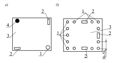
Рис. 4. Схема испытания плит, опертых по четырем углам (a) и опертых по четырем сторонам ( $\delta$ ): 1- шар; 2- каток; 3- испытываемая плита; 4- неподвижная опора
