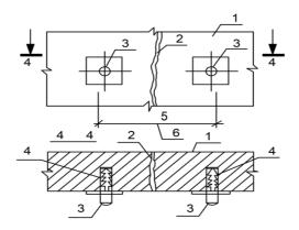
Рис. 40. Трещиномер для длительных наблюдений: 1 — строительная конструкция; 2 — трещина; 3 — марка, представляющая цилиндр из нержавеющей стали с полушаровой головкой, укрепленный на квадратном фланце из листовой стали; 4 — анкер, приваренный к фланцу (служит для крепления марки к конструкции); 5 — расстояние между марками, измеряемое штангенциркулем
