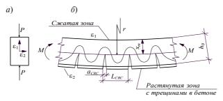
Рис. 18. Деформации элементов при сжатии (a) и изгибе ( $\delta$ ):  $\epsilon_1$ ,  $\epsilon_2$  — деформации сжатия и растяжения; r — радиус кривизны;  $a_{crc}$  — ширина раскрытия трещины;  $L_{CRC}$  — расстояние между трещинами;  $x_m$  — средняя высота сжатой зоны бетона
