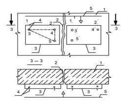
Рис. 34. Маяк конструкции Белякова: 1 — строительная конструкция; 2 — трещина; 3 — прямоугольные гипсовые или алебастровые пластины; 4 — металлические шпильки с острыми концами; 5 — измеритель линейных размеров
