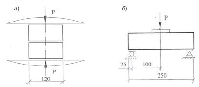
Рис. 43. Схемы испытания кирпичей: a — на сжатие;  $\delta$  — на изгиб
