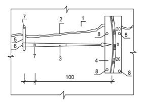
Рис. 38. Стрелочно-рычажный маяк: I — строительная конструкция; 2 — трещина в конструкции; 3 — стрелка; 4 — мерная шкала, градуированная через 1 мм; 5 — планка; 6 — шарнирное крепление стрелки к планке; 7 — шарнирное крепление стрелки и планки к конструкции; 8 — крепление мерной шкалы к конструкции с одной стороны от трещины
