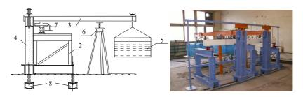
Рис. 9. Схема установки: I — испытываемый образец; 2 — опорная стойка балки; 3 — грузовой рычаг; 4 — опорная стойка рычага; 5 — грузовая емкость; 6 — страховочные стойки; 7 — динамометр ДОС-5; 8 — каналы силового поля
