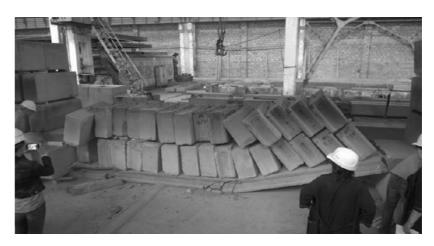
Рис. Б2. Разрушение плиты пустотного настила при загружении фундаментными блоками ФБС
