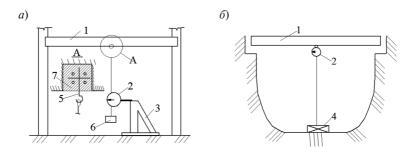
Рис. 20. Установка прогибомеров с проволочной связью: a — установка прогибомеров на независимой опоре;  $\delta$  — установка прогибомера на конструкцию; I — испытываемая конструкция; 2 — прогибомер; 3 — опора; 4 — якорь; 5 — фиксатор; 6 — груз; 7 — свинцовая пробка
