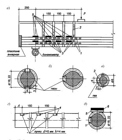
Рис. 47. Схема расположения тензорезисторов и магнитоупругих преобразователей (МУП) на арматуре: a — на продольной и поперечной арматуре в пролете среза;  $\delta$  — в пазах продольной арматуры;  $\epsilon$  — в пазах поперечной арматуры;  $\epsilon$  — в лунках продольной арматуры;  $\epsilon$  — МУП на продольной арматуре;  $\epsilon$  — цепочки тензорезисторов;  $\epsilon$  — одиночные тензорезисторы;  $\epsilon$  — тензорезисторы в лунках;  $\epsilon$  — МУП;  $\epsilon$  — столики
