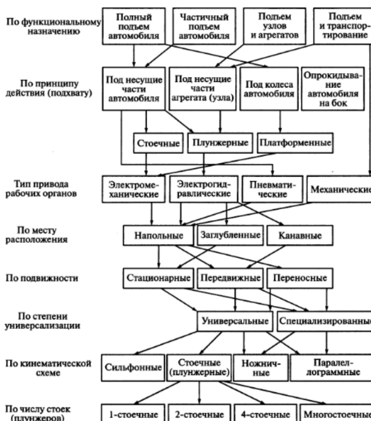
Рисунок 1 – Классификация подъемно-осмотрового и подъемно-транспортного оборудования
