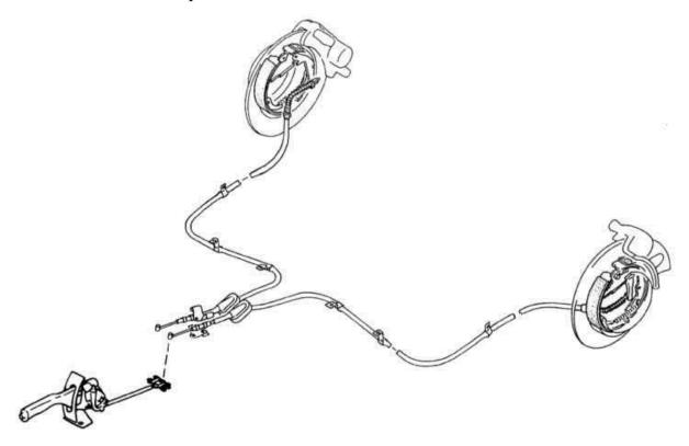
Рисунок 1.3 - Схема стояночного тормоза
