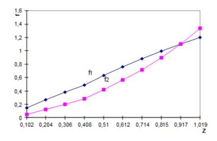
«Рисунок 2.6 – Распределение коэффициента сцепления по осям (полн. нагр.) »[5]
