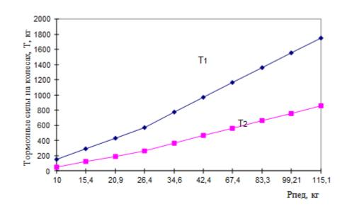
Рисунок 2.5 – Зависимость между усилием на педали и тормозными силами (полн. нагр.)
