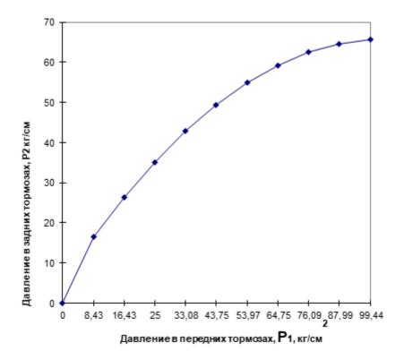
«Рисунок 2.2 — Характеристика регулятора давления задних тормозов(с част. нагр.) »[5]
