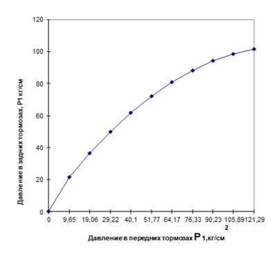
«Рисунок 2.1 — Характеристика регулятора давления задних тормозов (с полн. нагр.) »[5]
