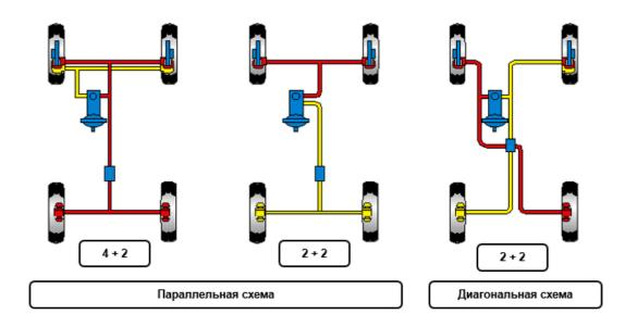
Рисунок 1.2 - Виды контуров тормозной системы
