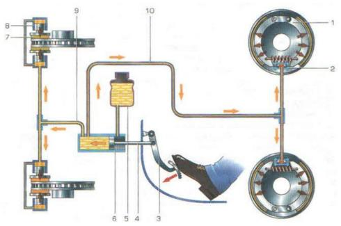
Рисунок 44. Общая схема тормозной системы легкового автомобиля:
