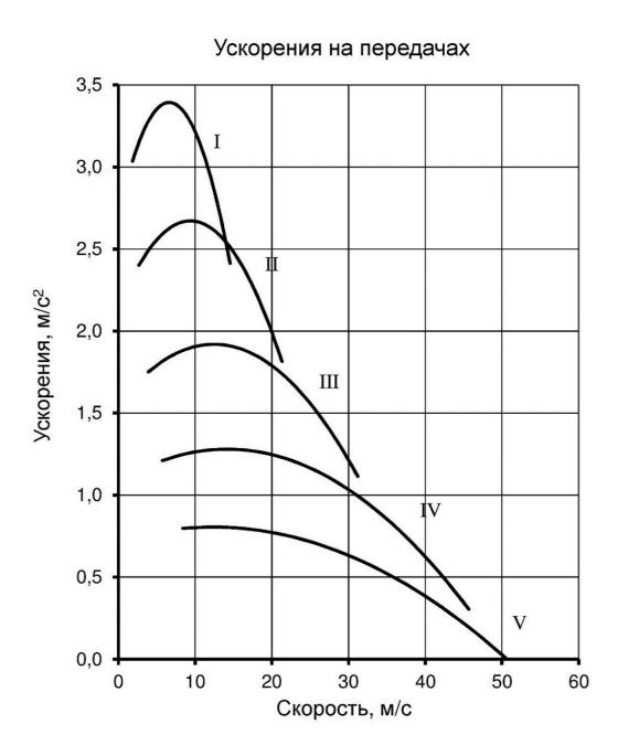
Рисунок А.5 – Ускорения на передачах
