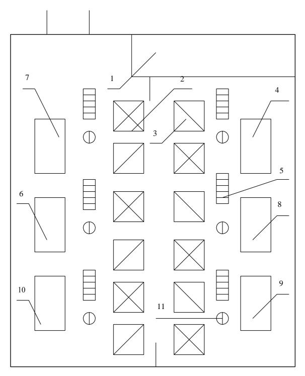
1-место для отдыха; 2-сверлильный станок; 3-пресс; 4-конрольный стенд; 5-контрольный стенд; 6-балансировочный станок; 7-клепальный полуавтомат; 8-контейнер с заготовками; 9-контейнер с деталями; 10-документация; 11-рабочее место.
