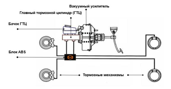
Рисунок 1.1 - Схема тормозной системы автомобиля
