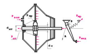
«Рисунок 2.3 - Схема работы вакуумного усилителя»[5]
