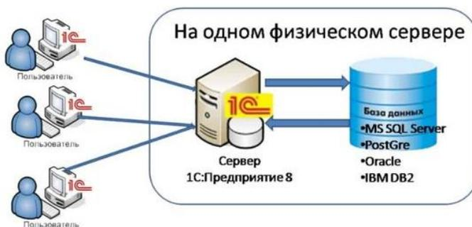
Рисунок 1.7 – Схема работы в клиент-серверном режиме.
