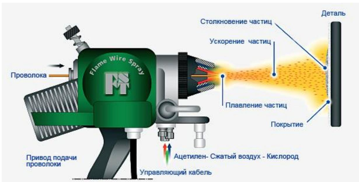
Рисунок 14 – Схема проволочного газопламенного напыления
