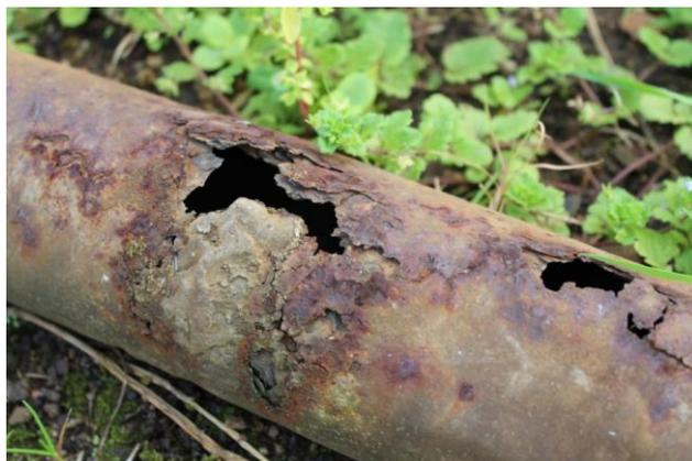
Рисунок 10 – Почвенная коррозия труб
