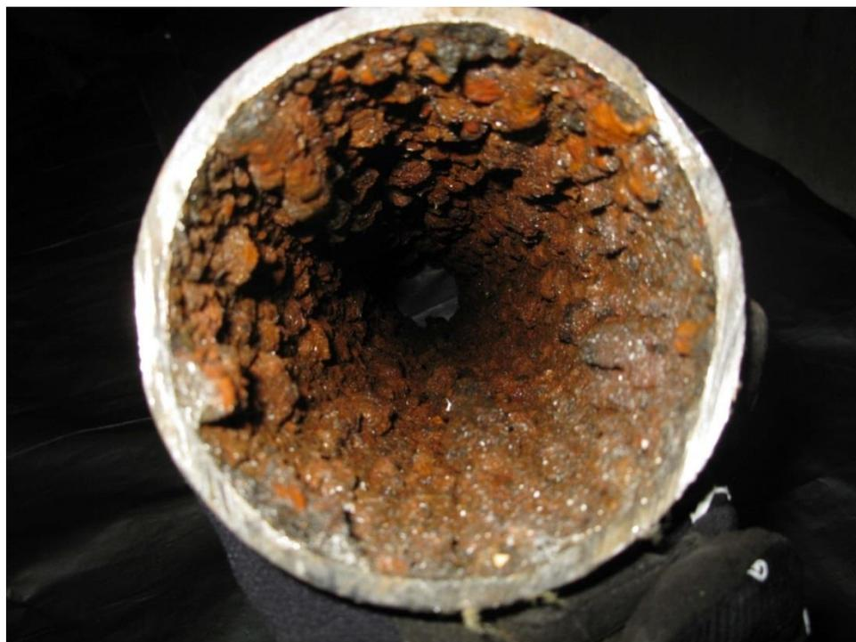
Рисунок 3 – Газовая коррозия стали
