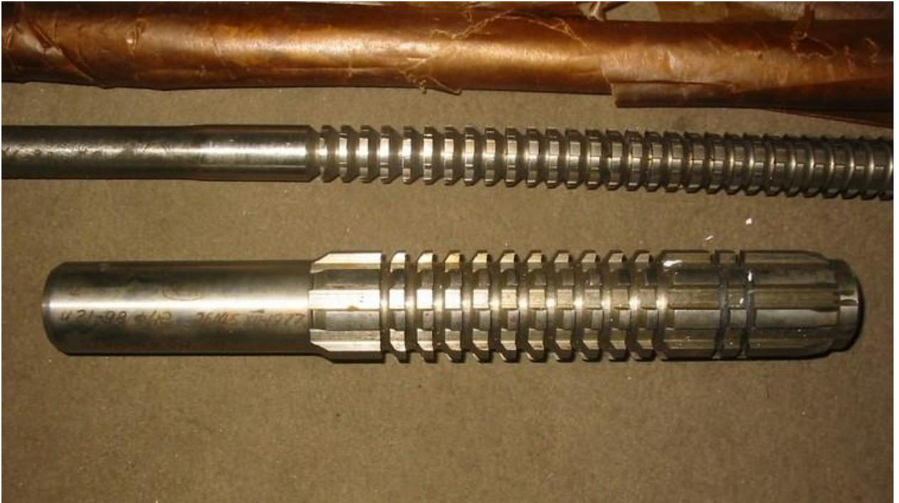
Рисунок 34 – Протяжка с малым отношением длины к диаметру
