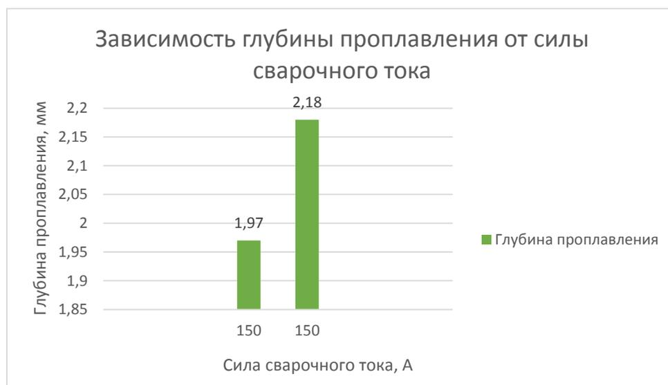
Рисунок 47 – Гистограмма зависимости глубины проплавления от силы сварочного тока
