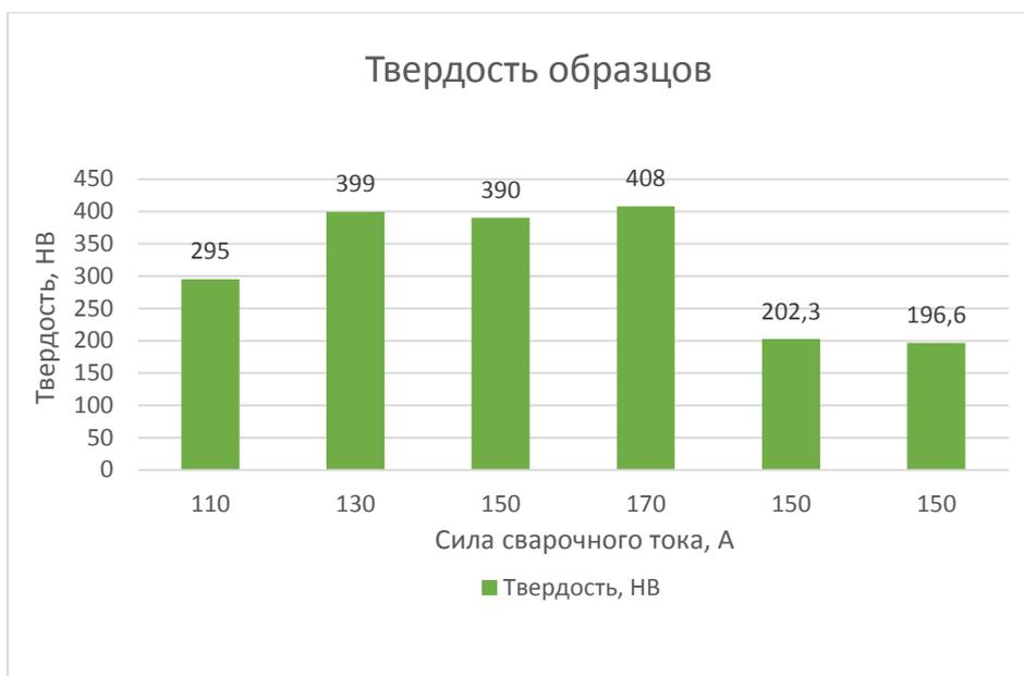
Рисунок 63 – Твердость образцов, НВ
