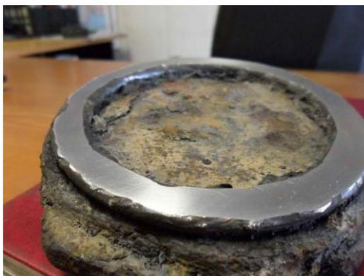
Рисунок 69 – Клин, подготовленный к наплавке
