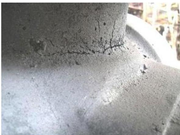
Рисунок 15 – Горячая трещина литья корпуса задвижки
