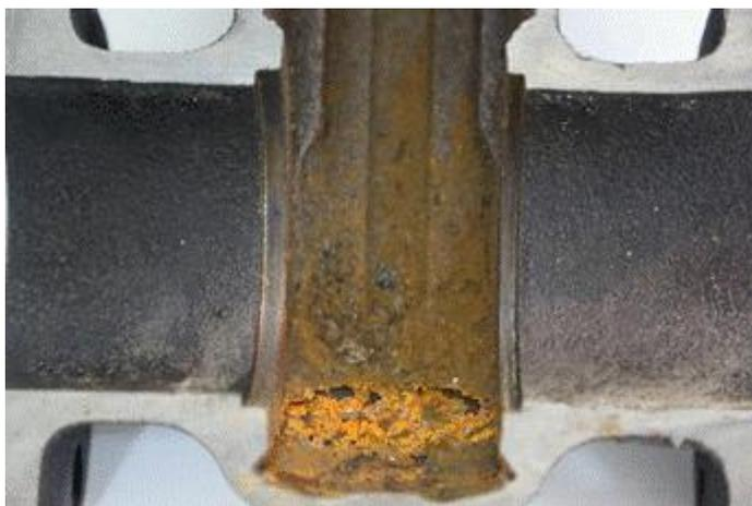
Рисунок 21 – Коррозия в корпусе задвижки
