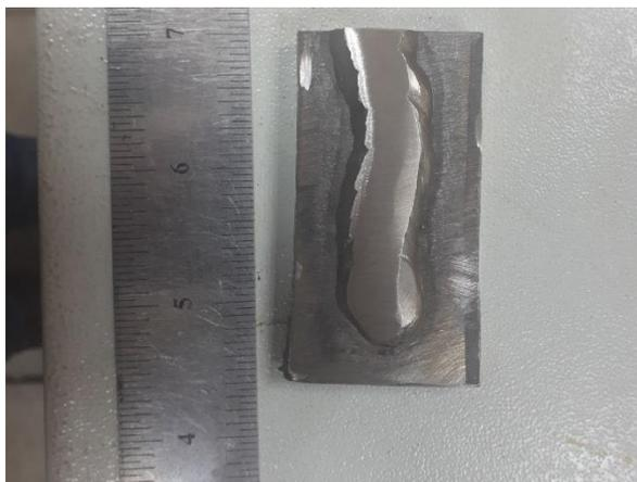
Рисунок 41 – Подготовленный образец для испытаний на твердость
