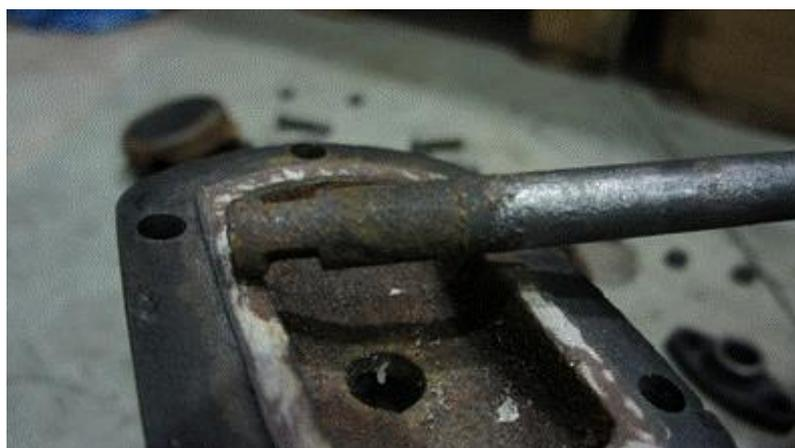
Рисунок 19 – Коррозия штока задвижки
