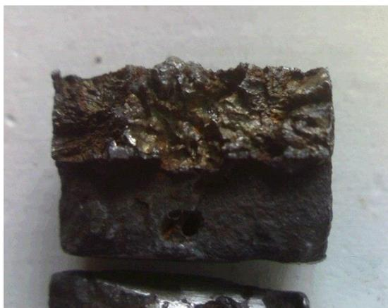
Рисунок 11 – Межкристаллитная коррозия ушек клина
