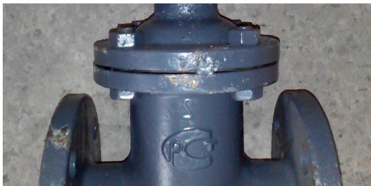
Рисунок 22 – Некачественный ремонт задвижки
