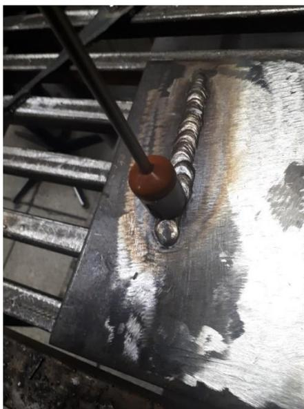
Рисунок 33 – Измерение температуры наплавленного валика
