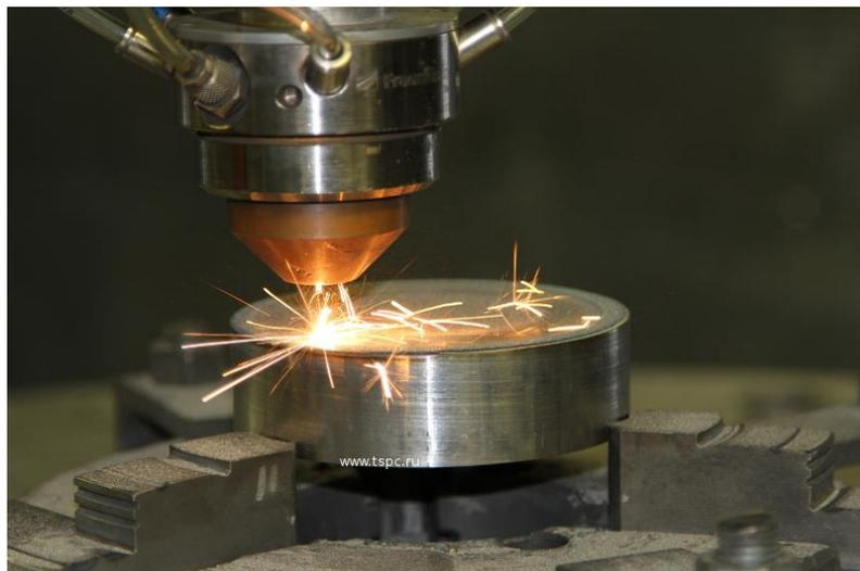
Рисунок 30 – Лазерная наплавка
