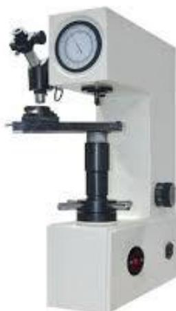
Рисунок 43 – Твердомер универсальный ИТБРВ–187,5–А
