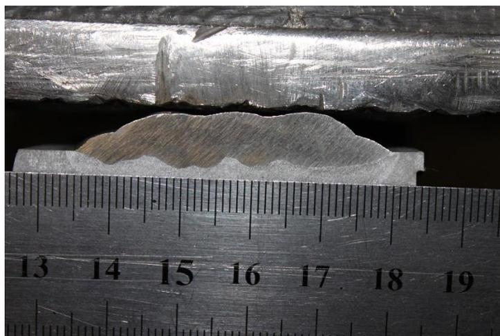
Рисунок 35 – Поперечное сечение двухслойной наплавки
