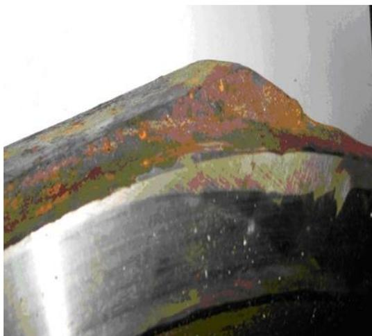
Рисунок 17 – Неправильная механическая обработка клина
