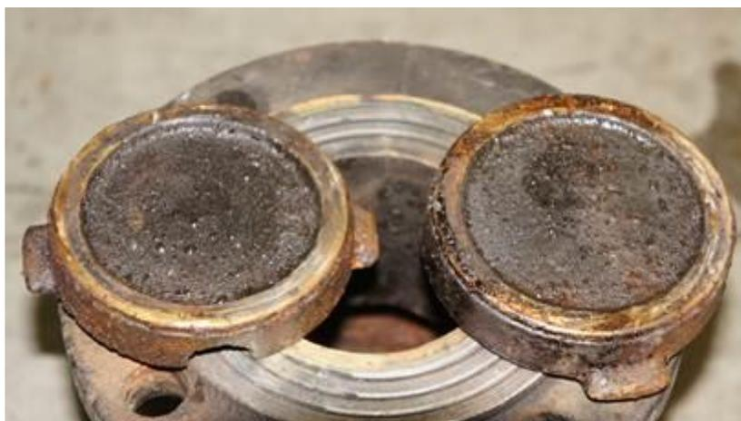
Рисунок 20 – Коррозия уплотнительных поверхностей клина задвижки
