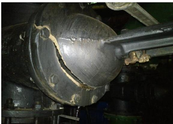
Рисунок 14 – Разлом крышки задвижки
