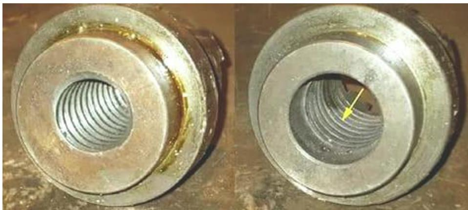
Рисунок 16 – Отсутствие резьбы на ходовой гайке
