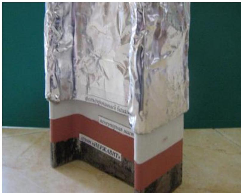
Рисунок 10 - Внешний вид металлической конструкции с нанесением конструктивного огнезащитного состава CompositTherm STEEL (СТ-S)
