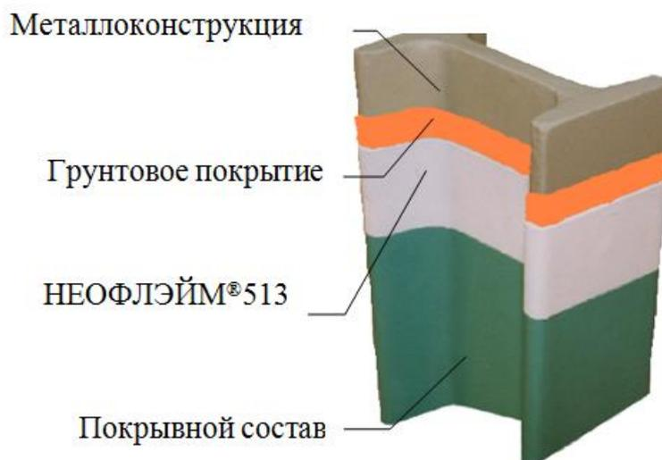
Рисунок 7 - Порядок нанесения огнезащитной краски НЕОФЛЭЙМ®513 и покрывного слоя на двутавровую балку
