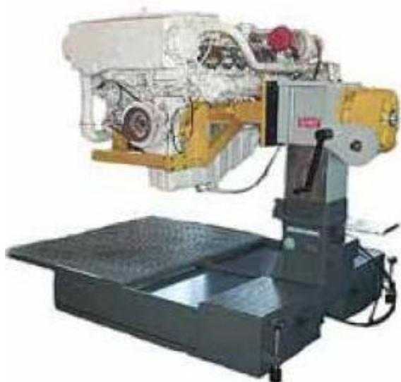
Рисунок 4 – Стенд для проведения ремонтных работ по двигателям и агрегатам грузовых автомобилей WW-HV-2500
