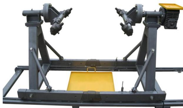
Рисунок 5 – Стенд для проведения ремонтных работ по двигателям и агрегатам грузовых автомобилей ЛПН-087.00.000-02
