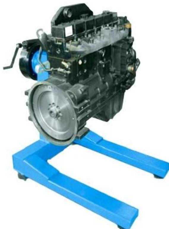
Рисунок 3 – Стенд для проведения ремонтных работ по двигателям и агрегатам грузовых автомобилей P1250
