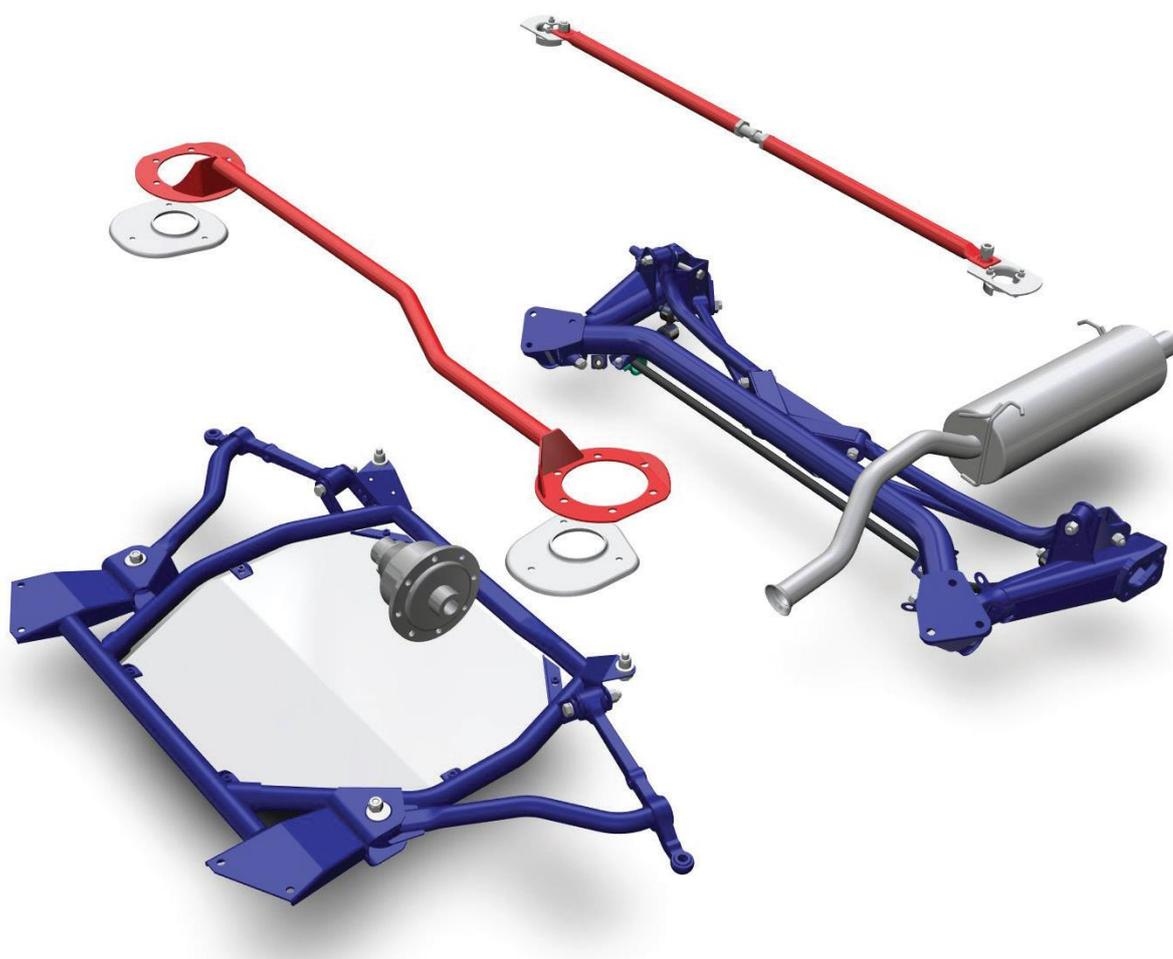
Рисунок 15 – Установочный комплект AUTOPRODUCT CROSS для автомобиля LADA Granta.
