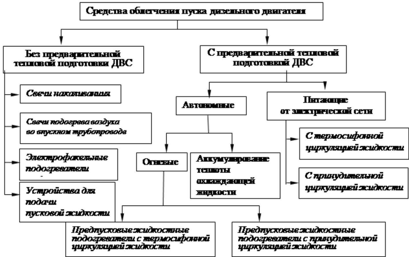
Рисунок 9 - Средства облегчения пуска дизельного двигателя
