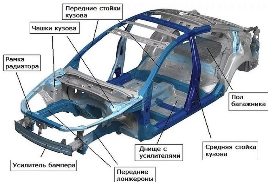
Рисунок 15 – Перспективные направления применения лазерной сварки на автомобилях ОАО «АВТОВАЗ»
