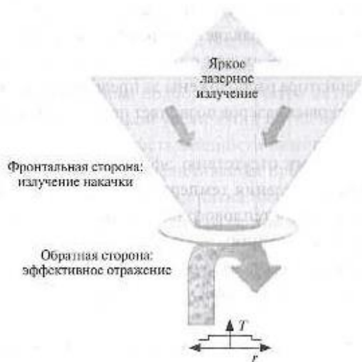
Рисунок 12 - принцип работы активного элемента дискового лазера.
