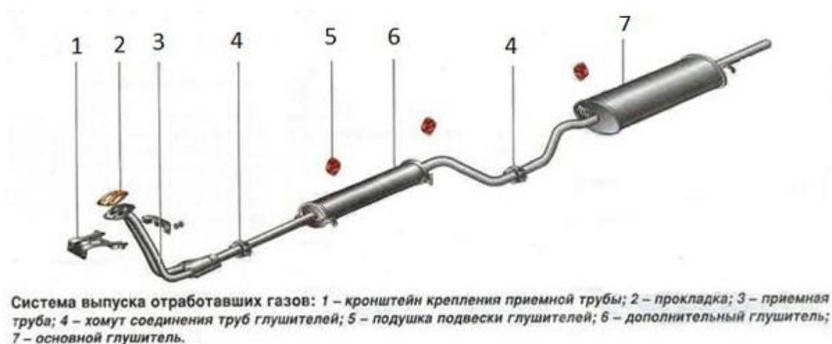
Рисунок 1 - Устройство системы отработанных газов
