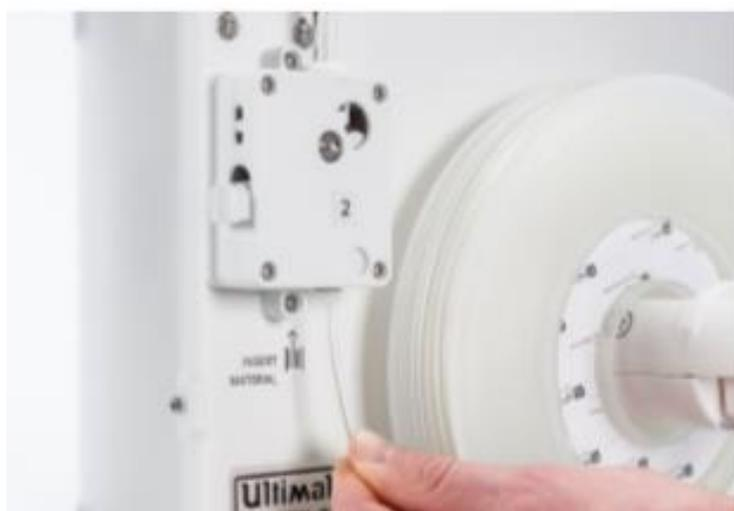
Рисунок 5.5 – Механизм подачи
