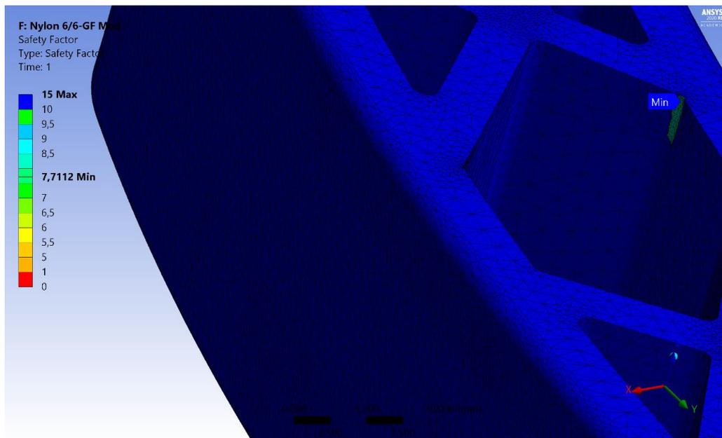
Рисунок 4.15 –Запас прочности модифицированной конструкции в области рычага (нагрузка по центру)
