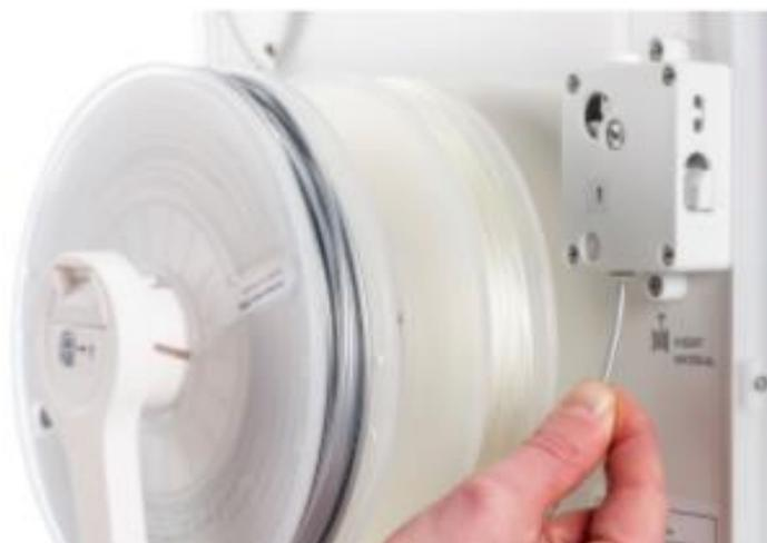
Рисунок 5.6 – Установка катушки
