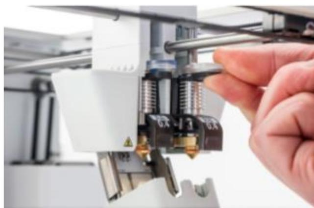
Рисунок 5.2 – Процесс установки экструдера ВВ
