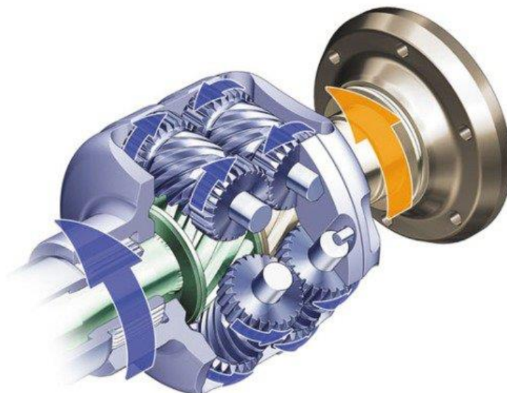
Рисунок 8 - Червячный дифференциал повышенного трения Torsen
