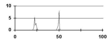
Рисунок 21 – характерный спектр вибраций подшипника скольжения с масляной гармоникой
