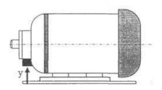
Рисунок 4 — Размещение вибродатчика перпендикулярно оси действия силы
