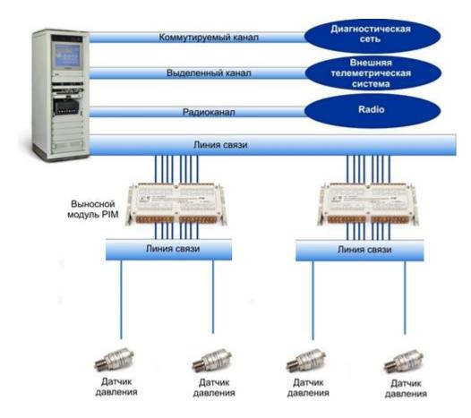
Рисунок 2 — Структурная схема системы
