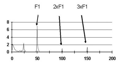
Рисунок 18 — характерный спектр вибрации ротора с небалансом
