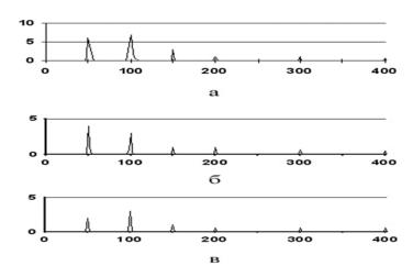
Рисунок 19 — характерный спектр вибрации агрегата с параллельной расцентровкой: а – вертикальная составляющая, б - горизонтальная составляющая, в — осевая составляющая
