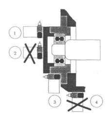
Рисунок 3 — Иллюстрация выбора крепления датчика
