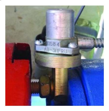
Рисунок 7 — Пример монтажа площадки для установки датчика
