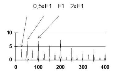
Рисунок 20 – характерный спектр вибрации агрегата с задеванием
