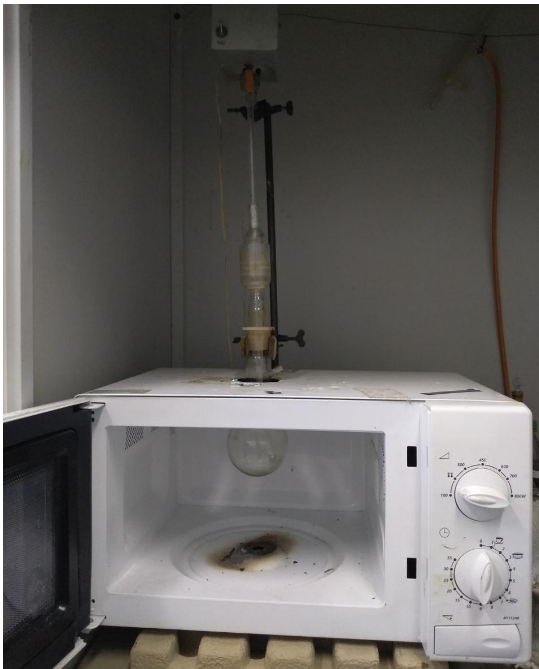
Рисунок 2.2а – Лабораторная микроволновая установка для получения поликонденсационных смол (с внутренним устройством).
