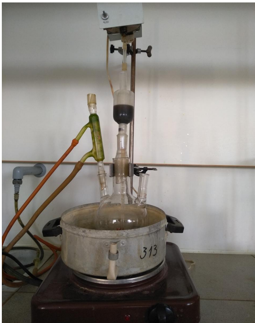
Рисунок 2.1 – Лабораторная установка получения смолы с традиционным способом нагрева.
