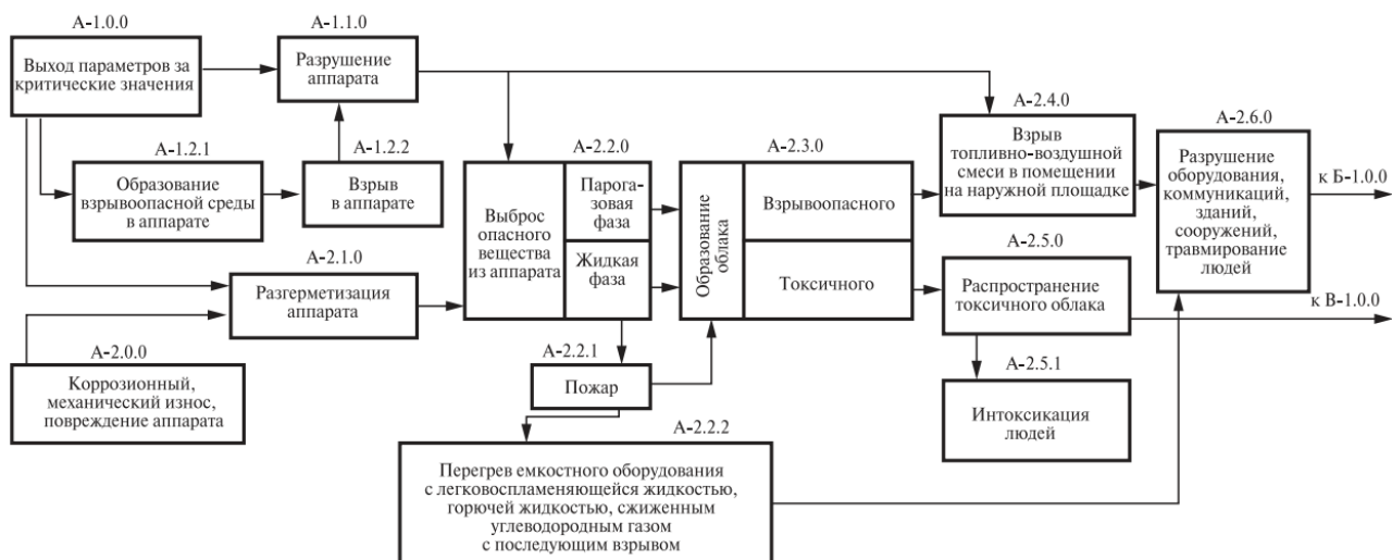
Рисунок 2.3 – Схема возникновения и развития аварии на установке ЭЛОУ-АВТ-6, обслуживаемой АО «Средне-Волжский штаб военизированных газоспасательных частей» [12]
