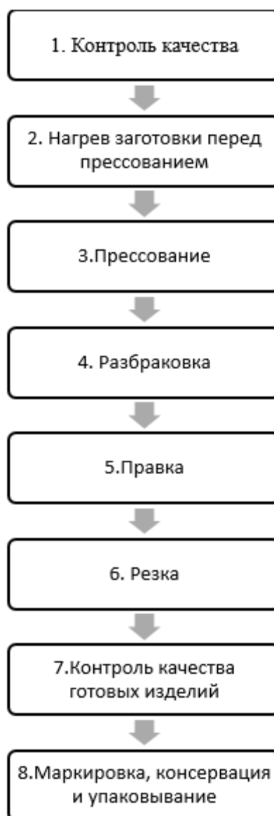
Рисунок 2.2 – Схема технологического процесса изготовления профилей из сплава АМгб
