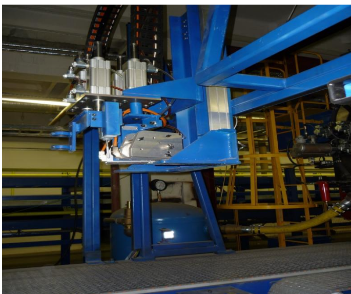
Рисунок 5 - Станция маркировки шины
