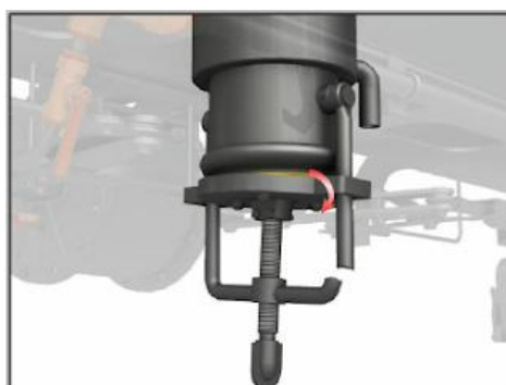
Рисунок 10 – Обрыв скобы крышки сливного прибора вагона 18-100 модели 19-923
