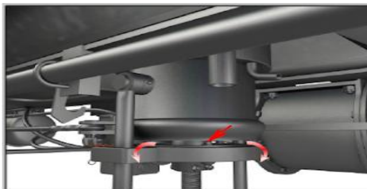
Рисунок 11 – Открытие крышки сливного прибора
