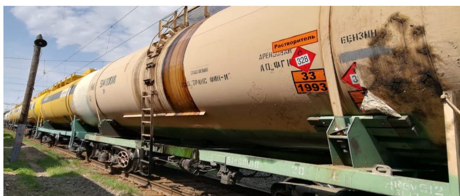
Рисунок 9 – Течь с верхнего сливного прибора вагона цистерны 18-100 модели 19-923 для перевозки растворителя
