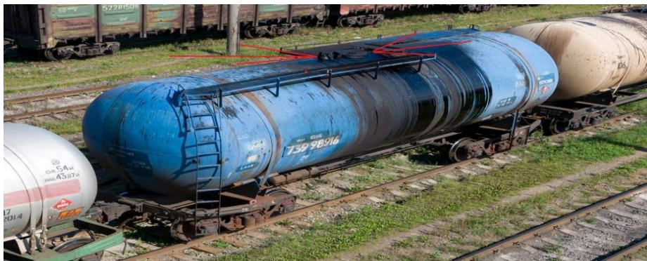
Рисунок 8 – Течь нефти вагона цистерны 18-100 модели 19-923
