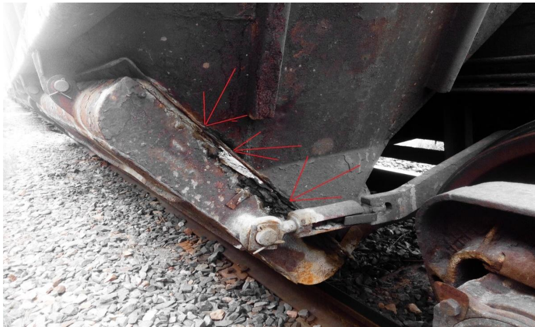
Рисунок 6 – Негерметичные резиновые кожухи вагона 18-100 модели 19-923
