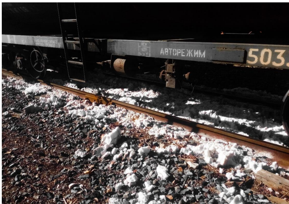
Рисунок 14 – Россыпь груза на пути станции
