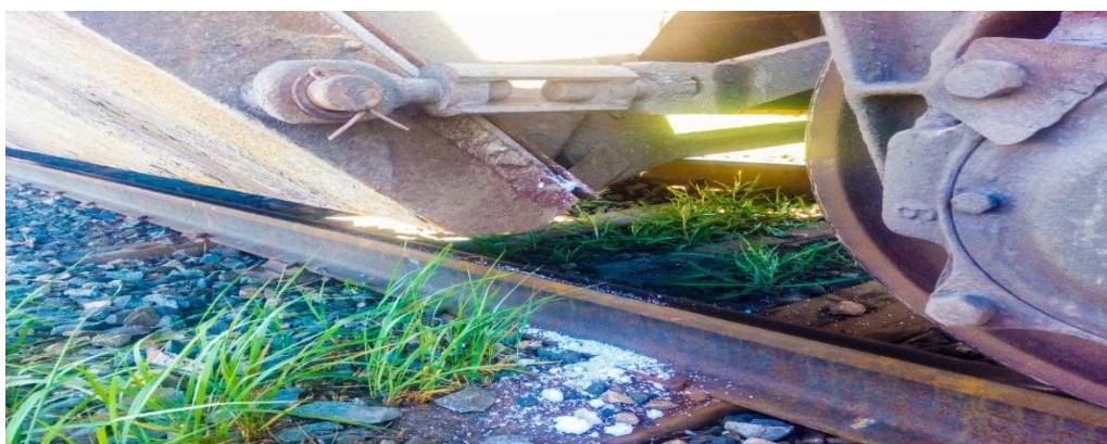
Рисунок 7 – Сыпь груза, через резиновые кожухи вагона для перевозки минеральных удобрений вагона 18-100 модели 19 923
