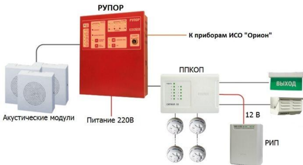
Рисунок 2 - Стандартная комплектация системы речевого оповещения
