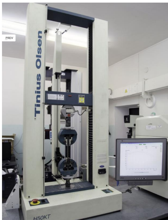
Рисунок 26 – Статическая испытательная машина Tinius Olsen H50KT.
