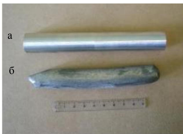
Рисунок 3 – (а) заготовка для РКУП, (б) образец после РКУП
