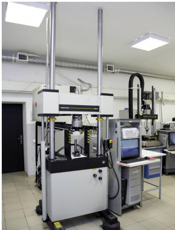
Рисунок 27 – Динамическая испытательная машина Instron 8802
