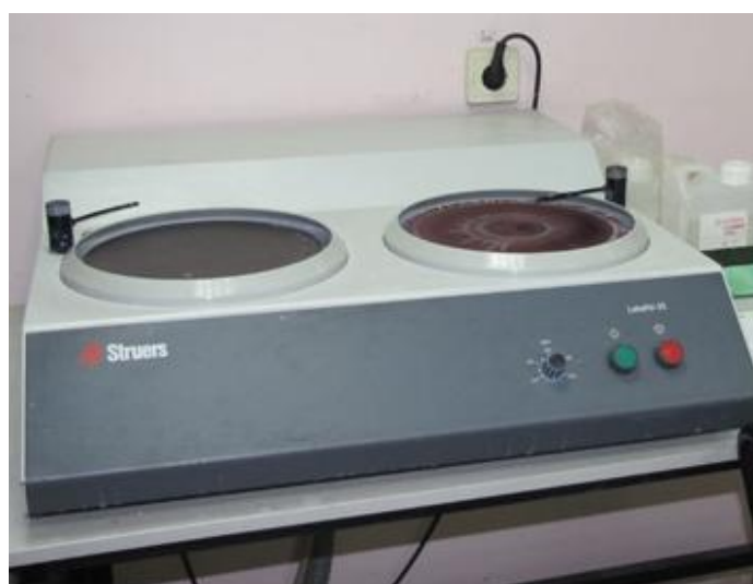
Рисунок 24 – Шлифовально-полировальный станок Struers LaboPol-25.
