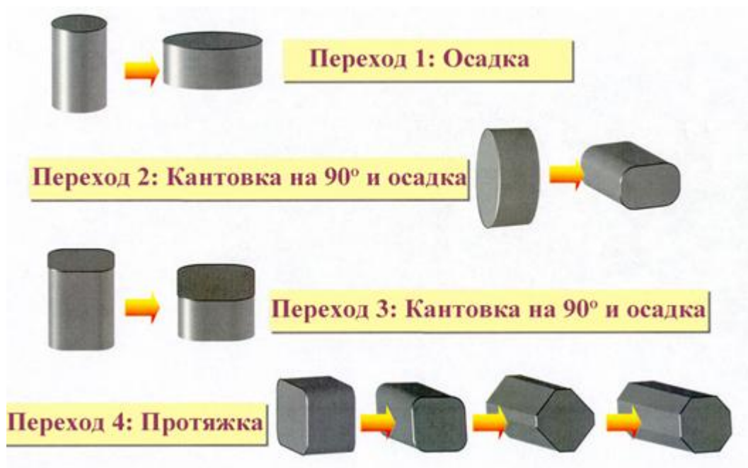
Рисунок 11 - Принципиальная схема всесторонней изотермической ковки [23]
