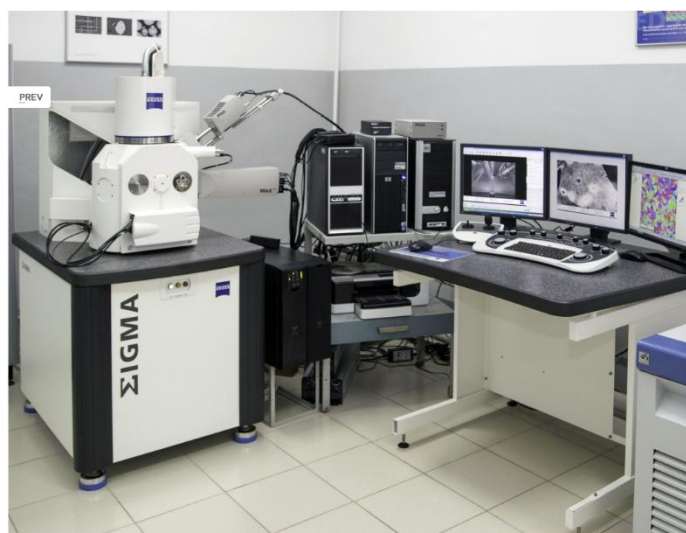
Рисунок 23 – Сканирующий электронный микроскоп Zeiss Sigma.
