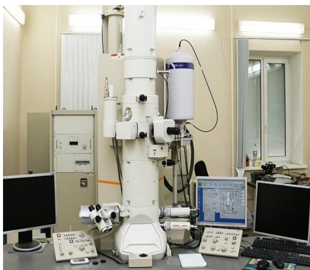
Рисунок 21 – JEM-2100F универсальный 200кВ просвечивающий электронный микроскоп с термополевой пушкой Шоттки.
