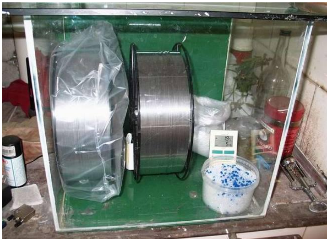
Рисунок 2.5 – Хранение катушек с алюминиевой проволоки
