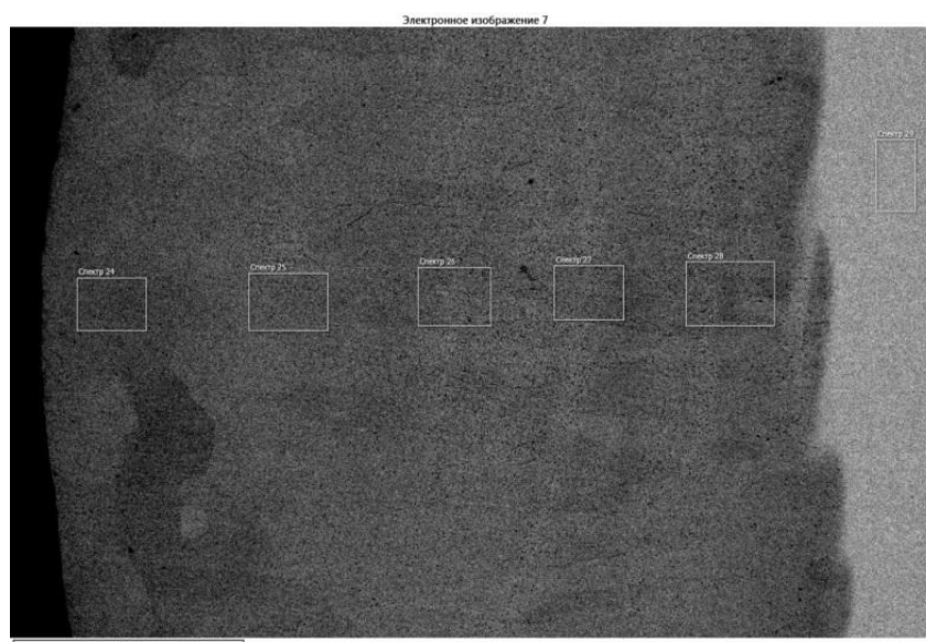
Рисунок 5.8 – Спектры, в которых измерялся химический состав способом РЭМ
