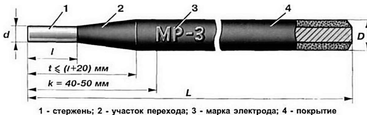
Рисунок 4.1 – Схематичное изображение покрытого сварочного электрода
