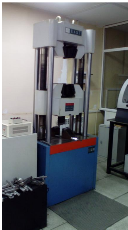
Рисунок 29 – Гидравлическая универсальная испытательная машина WAW-1000 F
