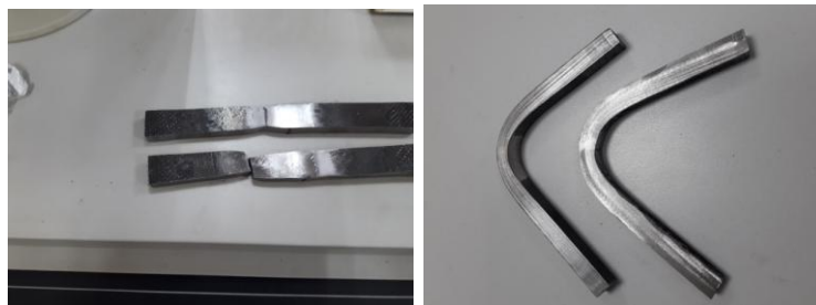
Рисунок 36 – Фотографии образцов № 6 после механических испытаний
