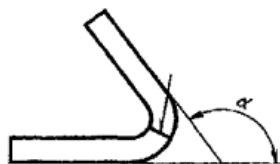
Рисунок 30 – Схема испытаний на статический изгиб
