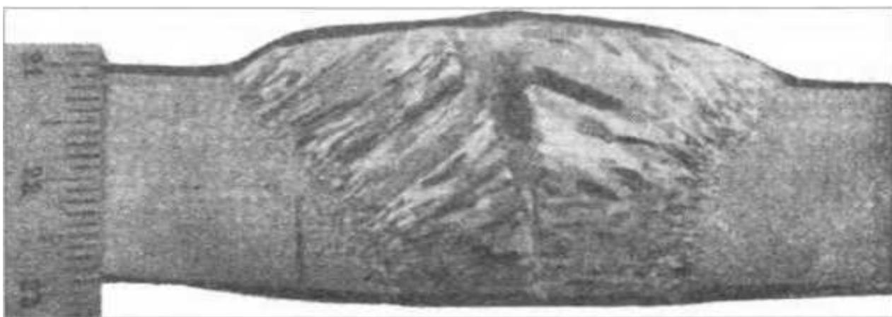
Рисунок 19- Макрошлиф сварного шва на меди толщиной 18 мм
