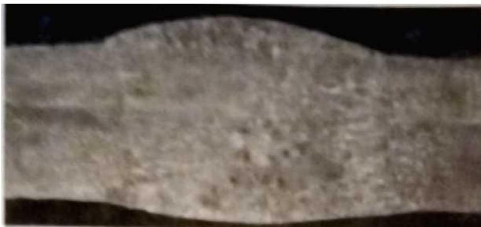
Рисунок 14. Макрошлиф стыкового соединения медных листов, выполненного под флюсом с принудительным формированием.
