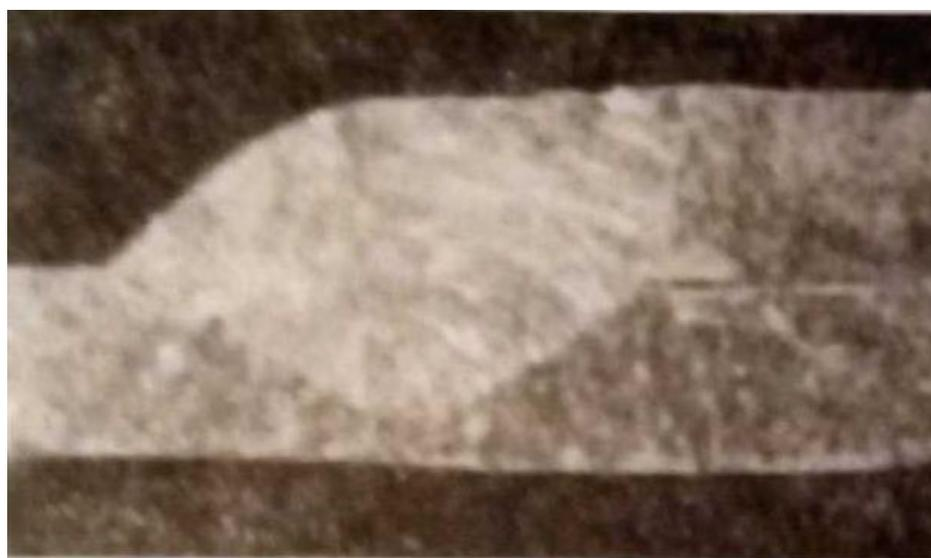
Рисунок 15. Макрошлиф нахлесточного соединения листов толщиной 5 мм, выполненного под флюсом.
