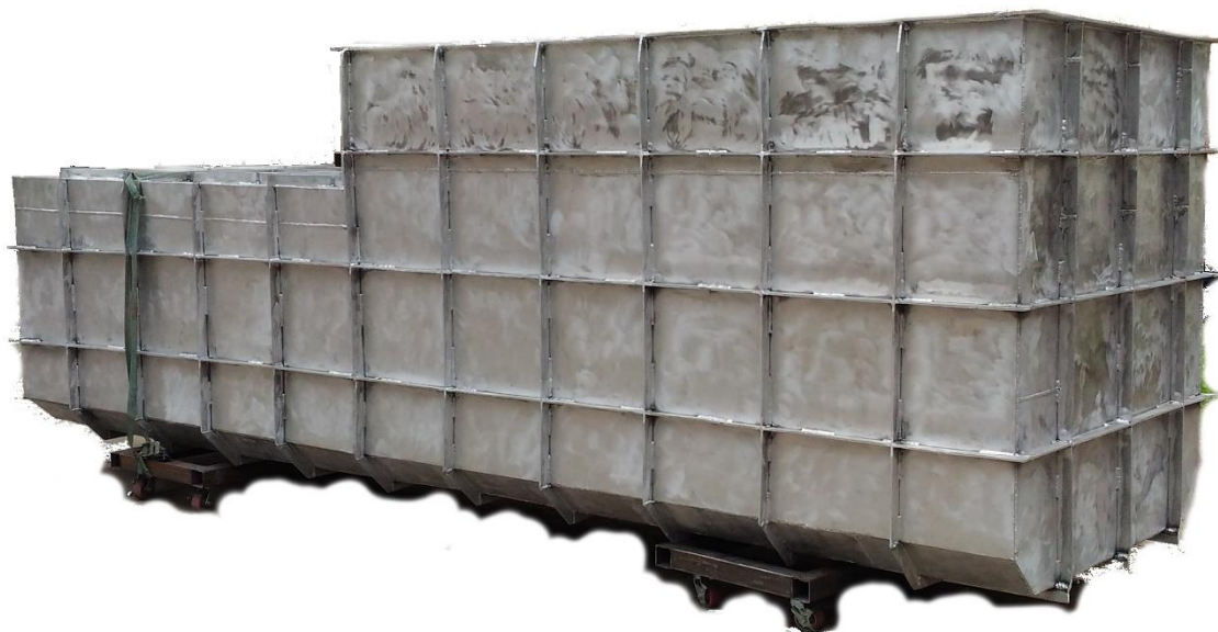
Рисунок 40 – Изготовленный короб алюминиевого воздуховода
