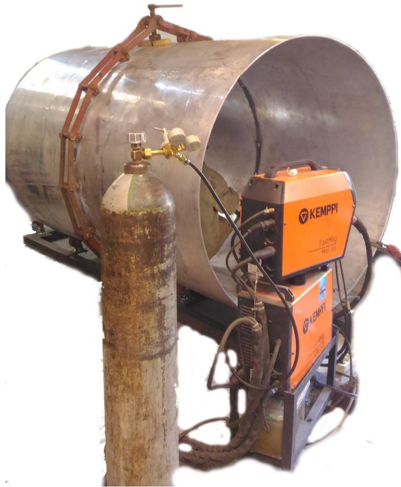
Рисунок 38 – Процесс изготовления алюминиевой обечайки
