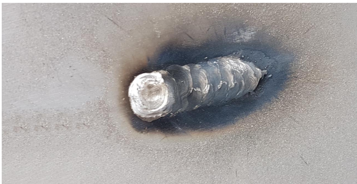
Рисунок 31 – Внешний вид валика наплавленного углом назад
