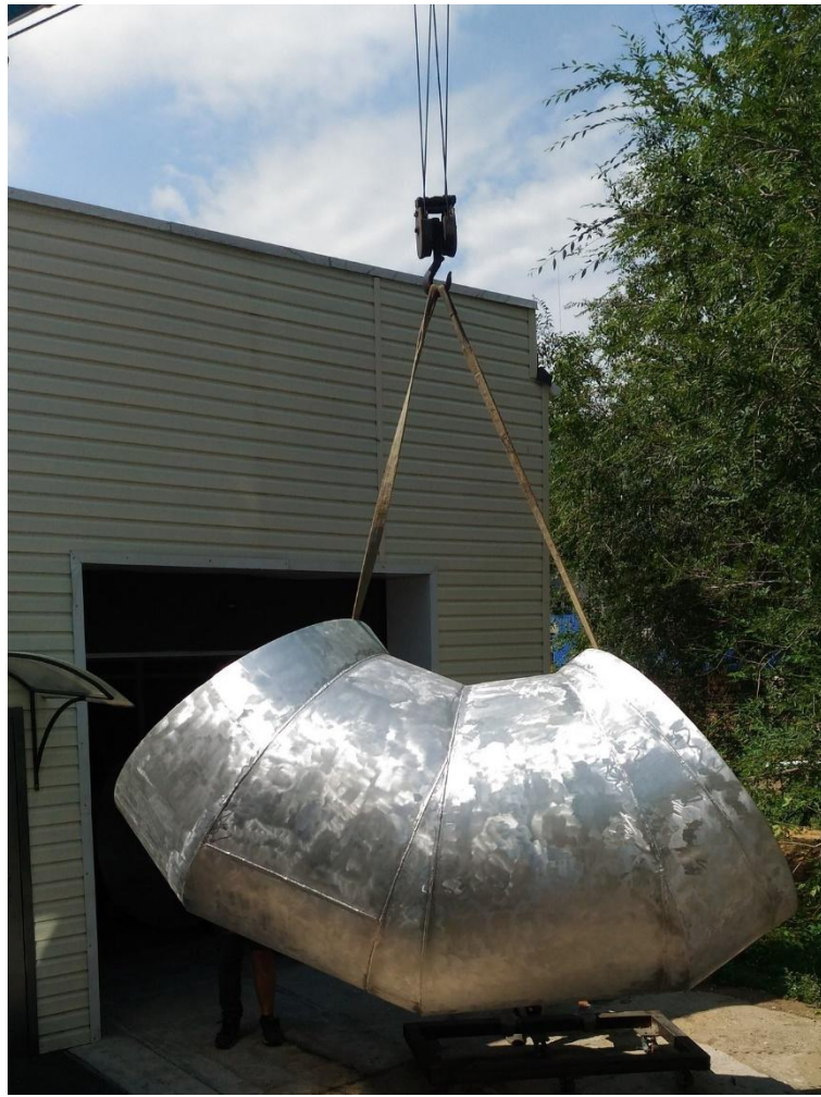
Рисунок 41 – Изготовленный отвод сварной 90-DN 1600
