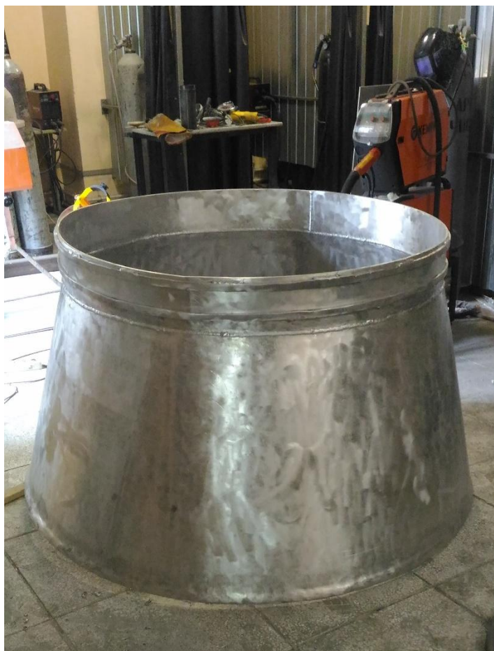
Рисунок 39 – Изготовленный переход DN 1600-1200
