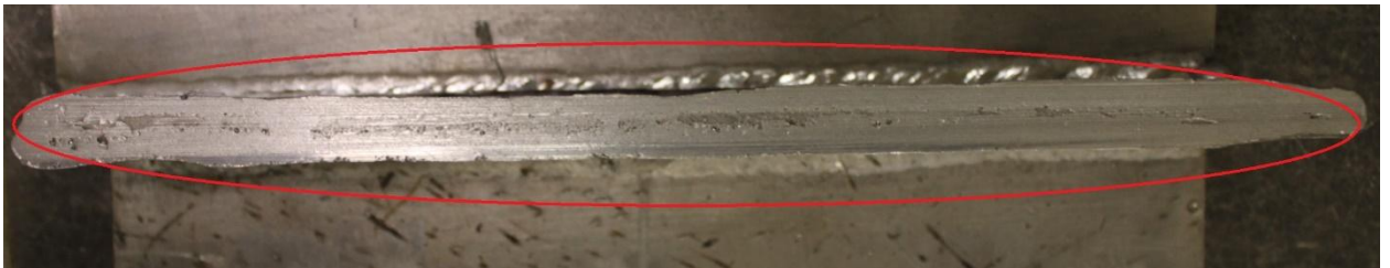
Рисунок 32 – Продольные разрезы стыков с дефектами в виде пор и цепочек пор
