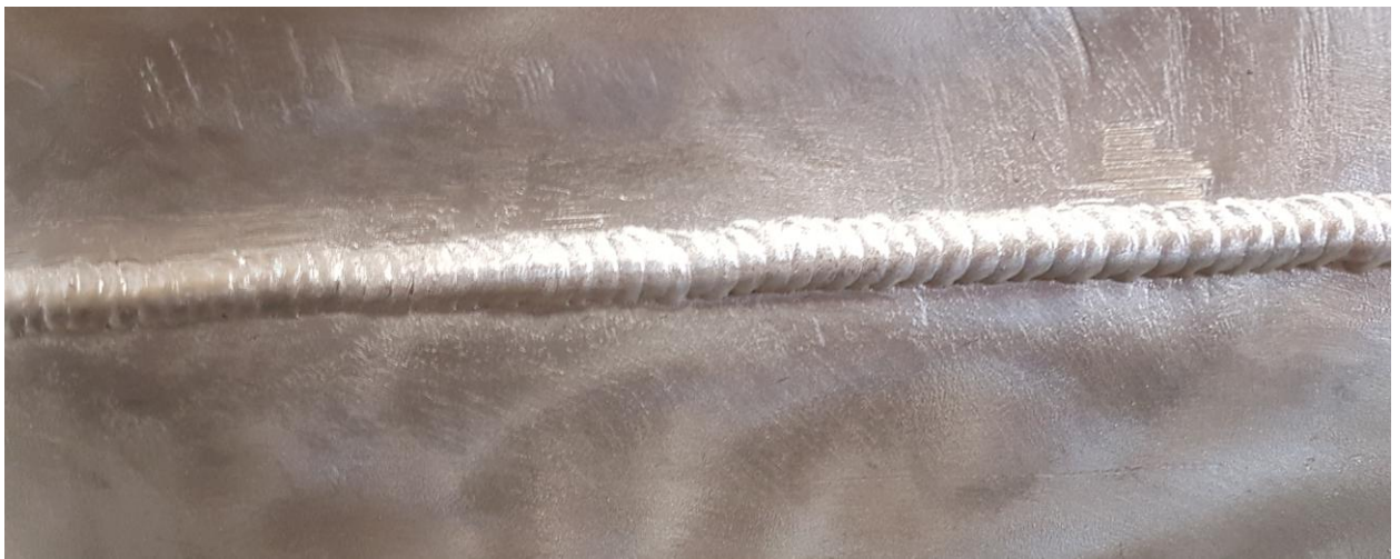
Рисунок 34 – Внешний вид сварного образца из алюминия сваренного по установленной технологии
