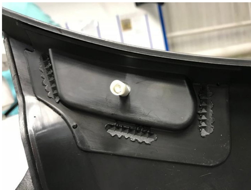
Рисунок 4.3 - Результат сварки пластиковой вставки с бампером
