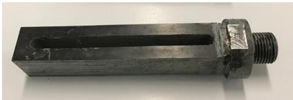
Рисунок 2.1 – Магнестрикционный преобразователь из пермендюра.
