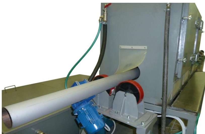
Рисунок 2.3 – Процесс очистки наружной поверхности трубы на гидроабразивной установке – УНОТ
