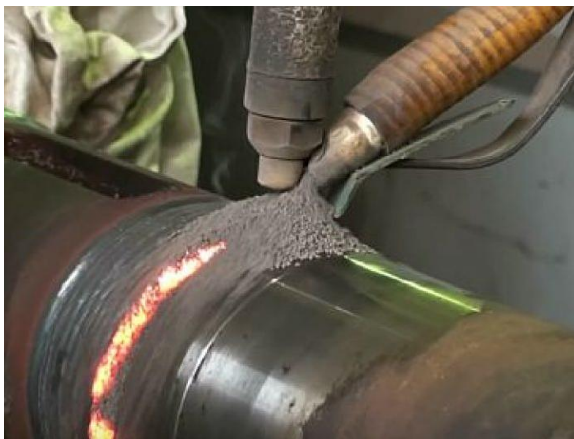
Рисунок 1.6 – Автоматическая сварка под флюсом
