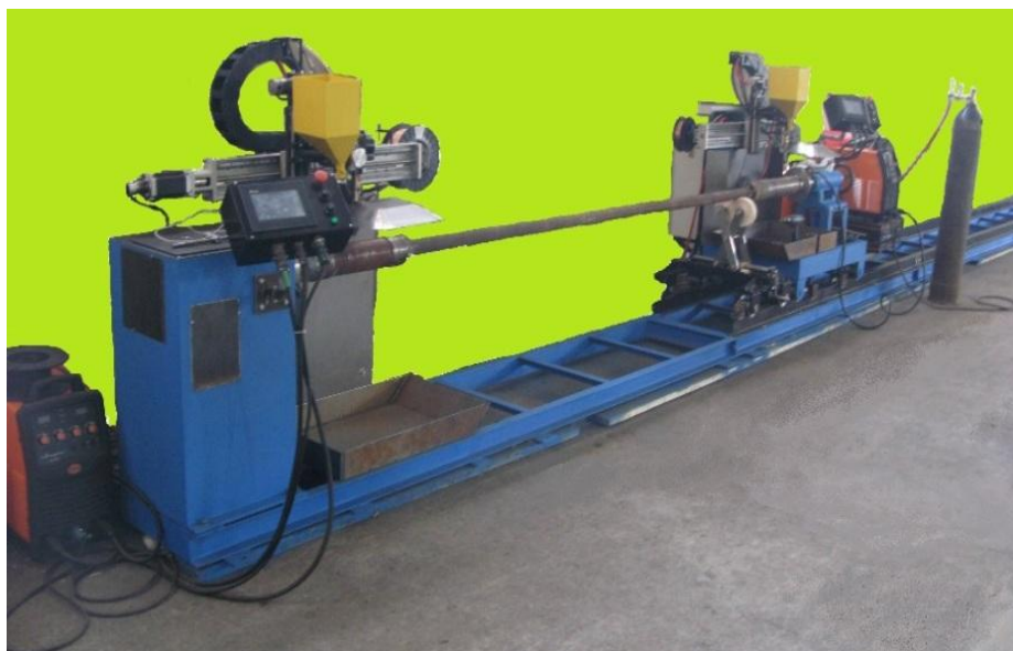
Рисунок 3.9-Установка для наплавки замков буровых труб УНБТ-1.0
