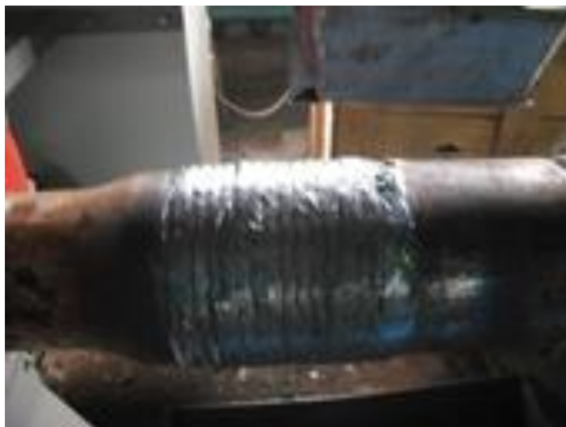
Рисунок 2.9 – Наплавленная поверхность муфты стальной бурильной трубы
