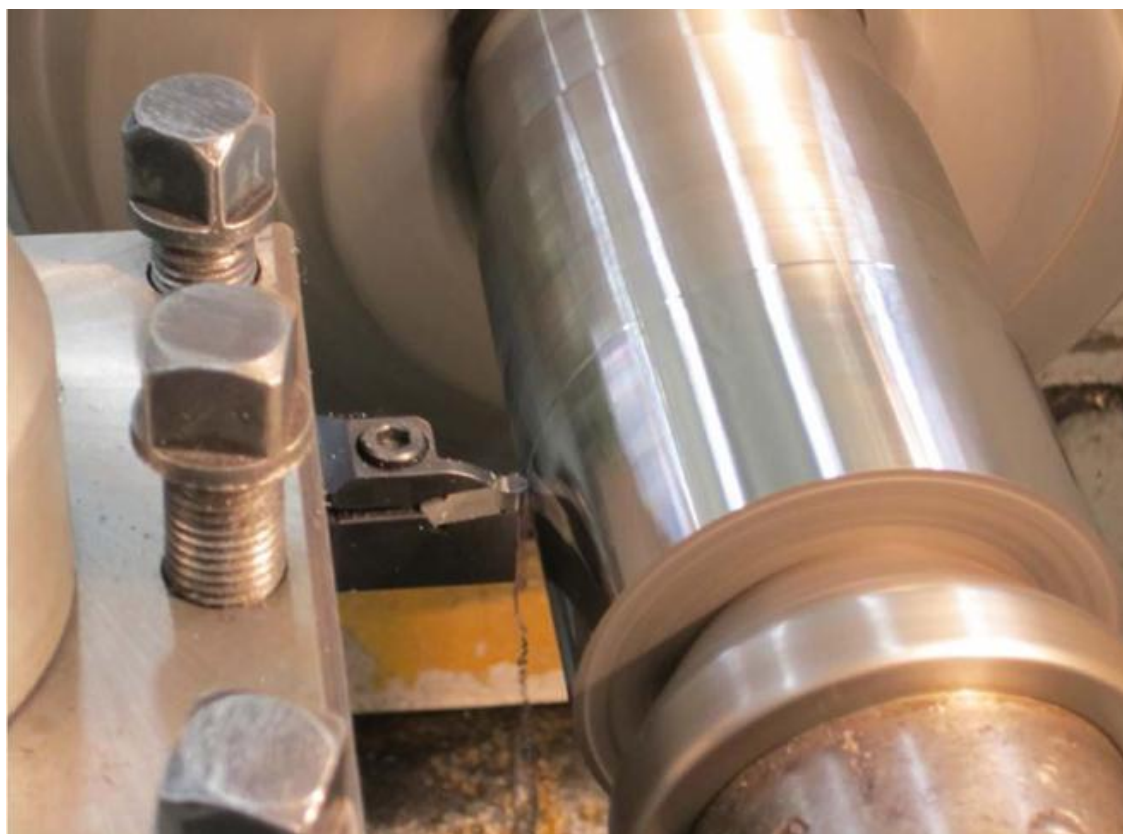
Рисунок 2.6 - Механическая обработка поверхности муфты
