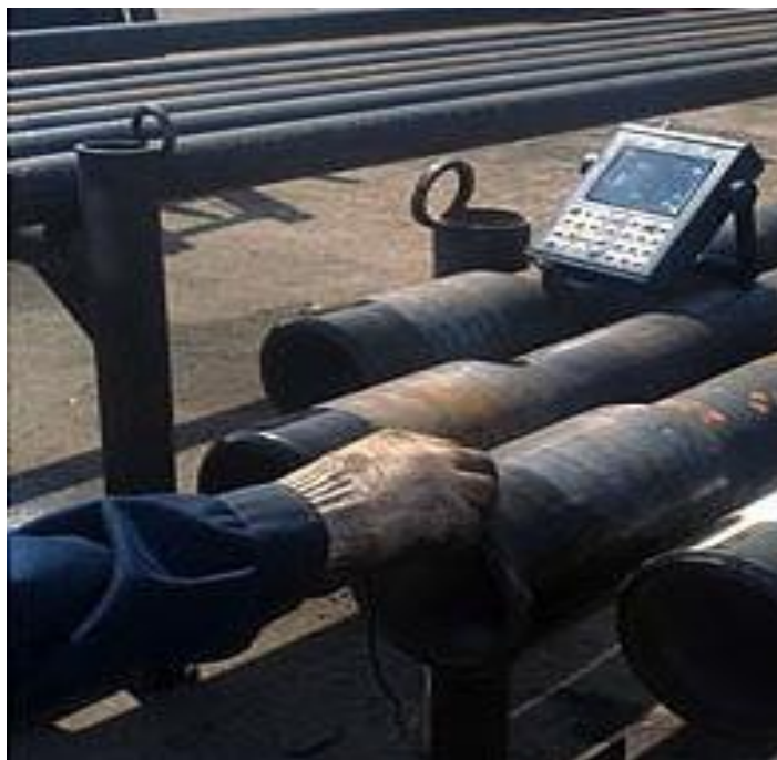
Рисунок 2.4 – Проверка поверхности муфты ультразвуковым дефектоскопом УДЗ-307 ВД PELENG
