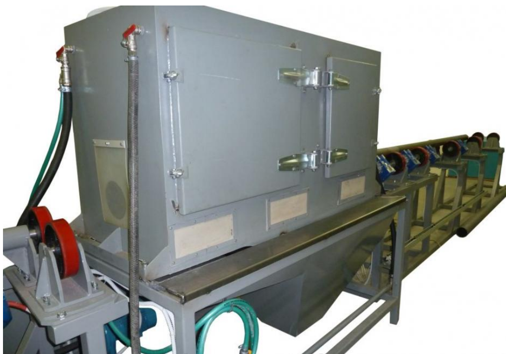
Рисунок 3.1-Установка для гидроабразивной очистки наружной поверхности труб – УНОТ
