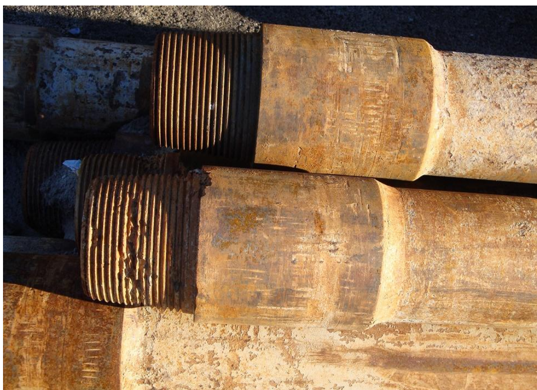
Рисунок 2.2– Трубы со значительными повреждениями
