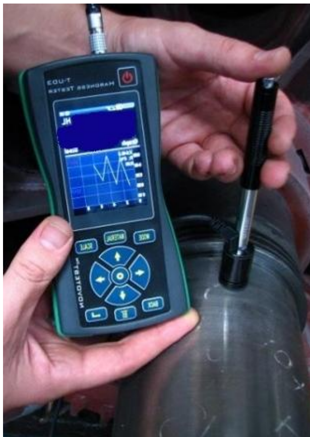
Рисунок 2.12 – Измерение поверхности муфты на твёрдость
