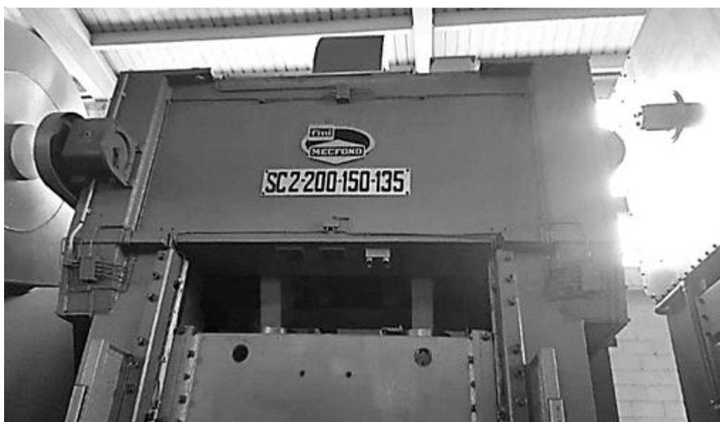
Рисунок 1.5 – Универсальный пресс автомат простого действия Mecfond модель SC2-200-150-135
