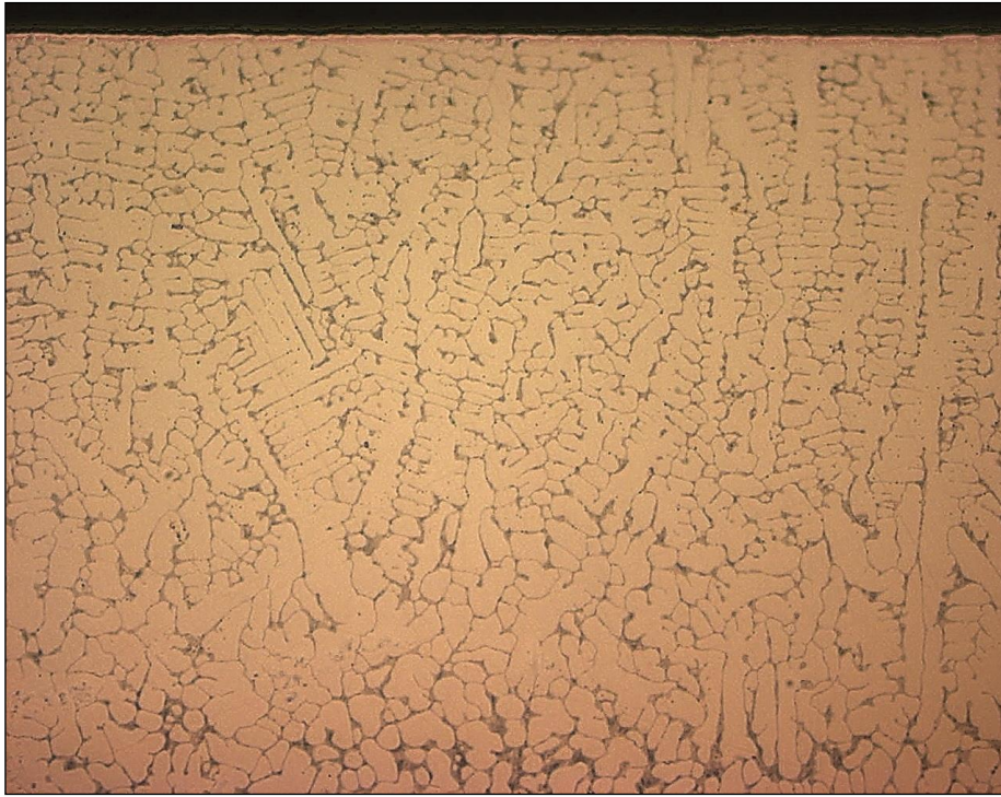
Рис. 4.7 – Микроструктура упрочненного слоя образца из стали X12МФ. ( \times 500 )
