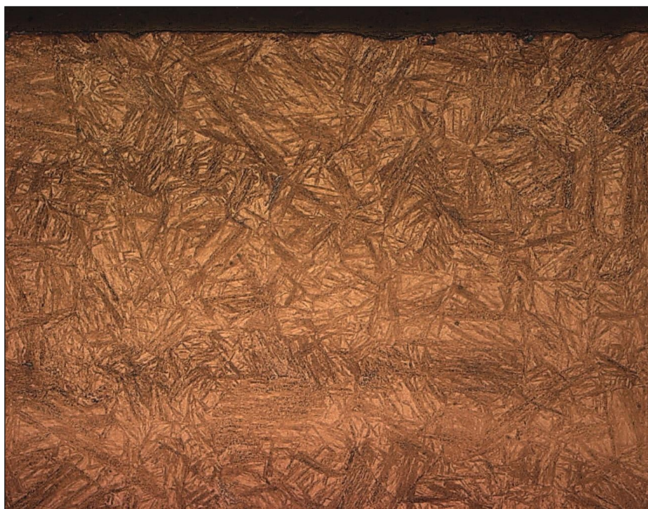
Рис. 4.11 – Микроструктура упрочненного слоя образца из стали 40Х. ( \times 500 )
