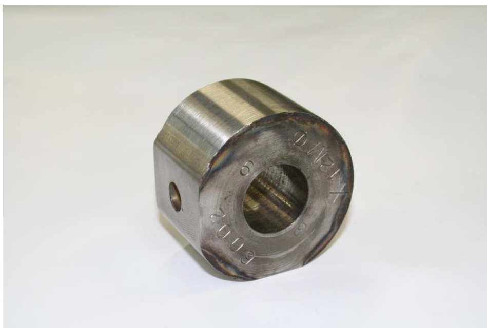
Рис. 4.6 – Образец из стали X12МФ после проведения плазменной закалки и операции шлифования.
