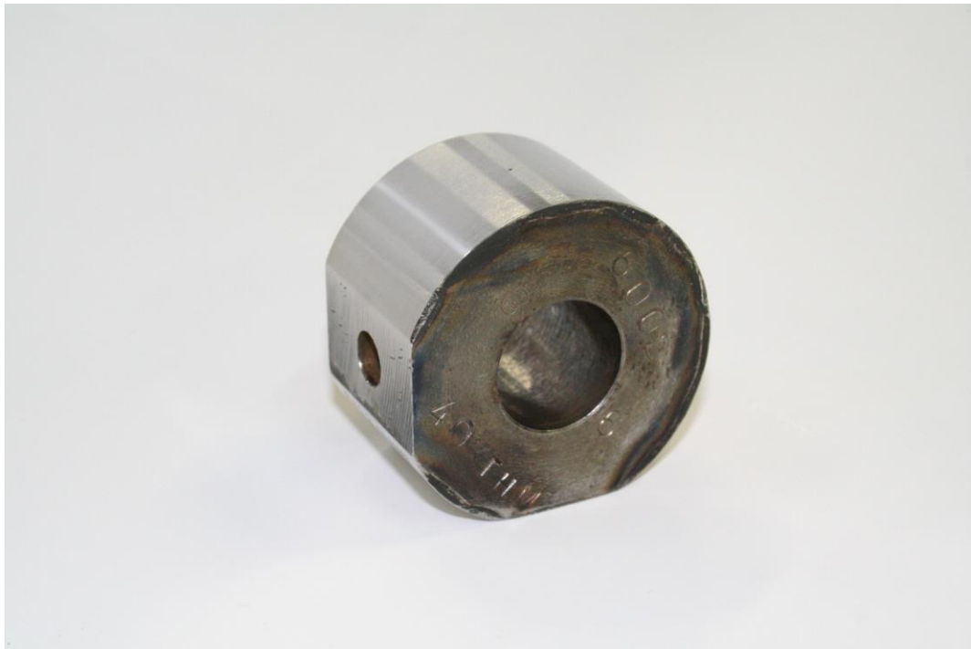
Рис. 4.10 – Образец из стали 40X после проведения плазменной закалки и операции шлифования.
