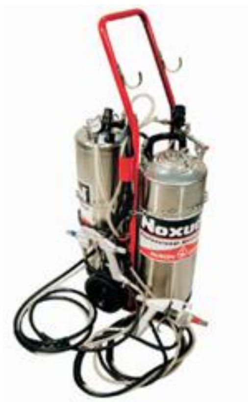
Рисунок 3.3 – Устройство для нанесения антикоррозионного материала воздушным методом
