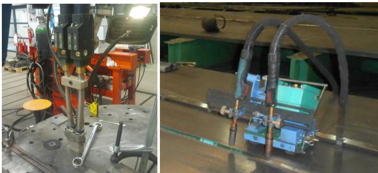
Рисунок 1.5 – Оборудование для двухдуговой тандемной сварки
