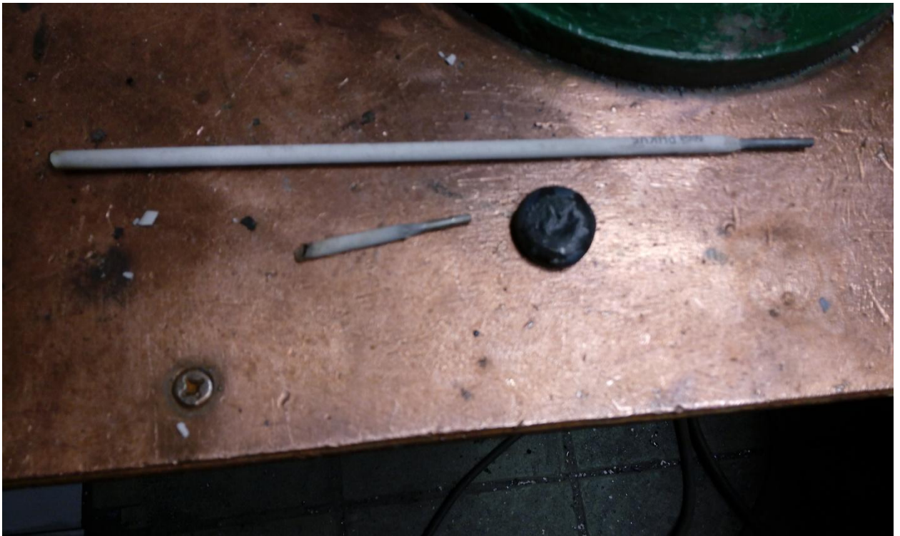
Рисунок 2.2– Внешний вид полученных проб наплавляемого металла
