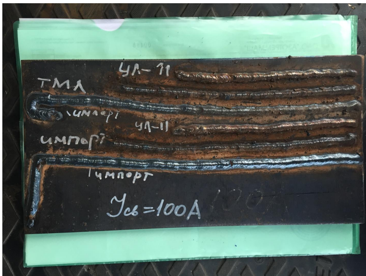
Рисунок 3.1 – Внешний вид наплавки несколькими марками электродов на токе 100 А
