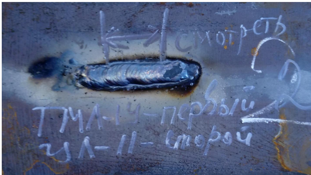
Рисунок 3.3– Внешний вид двухдуговой наплавки. Первая дуга – ТМЛ-1У, вторая дуга, ЦЛ-11
