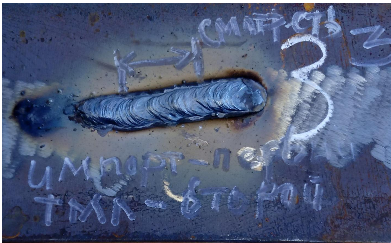
Рисунок 3. 2 – Внешний вид двухдуговой наплавки. Первая дуга – импортные электроды, вторая дуга – ТМЛ-1У
