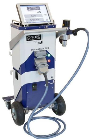
Рисунок 2.3 – Внешний вид прибора для спектрального анализа PMI MASTER
