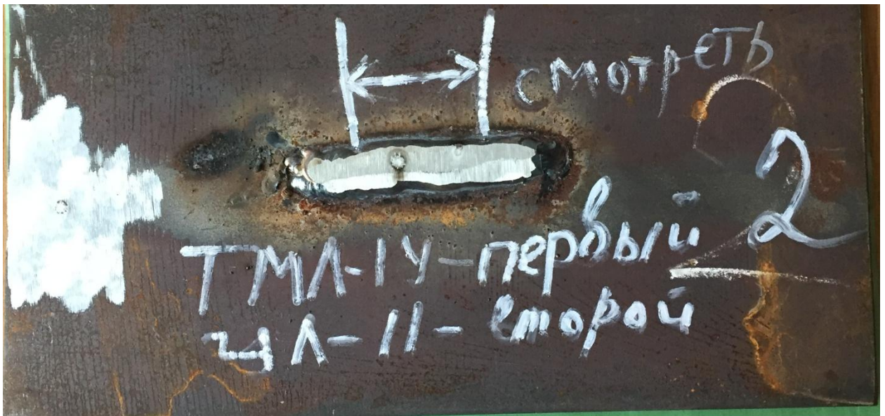
Рисунок 3.5– Внешний вид образца с точкой спектрального анализа
