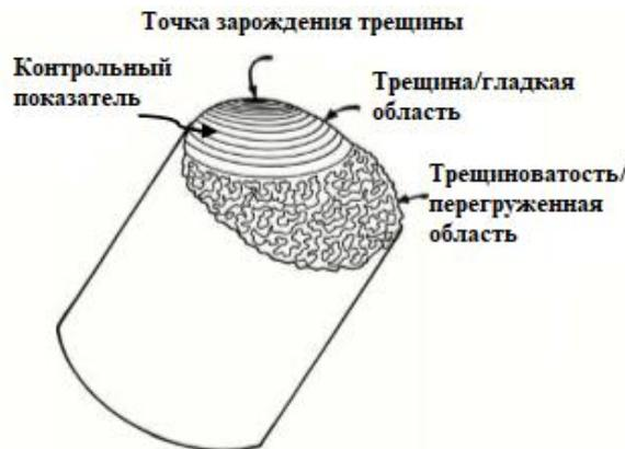
Рисунок 1.10 - Схема усталостного разрушения поверхности и ее частей.
