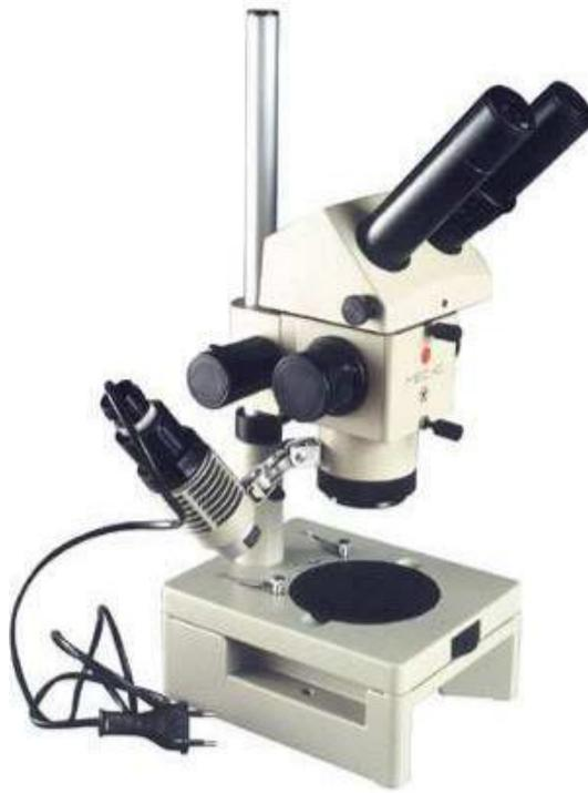
Рисунок 2.7 – Микроскоп МБС-9
