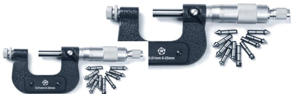
Рисунок 2.6 – Микрометр со вставками МВМ 0–25
