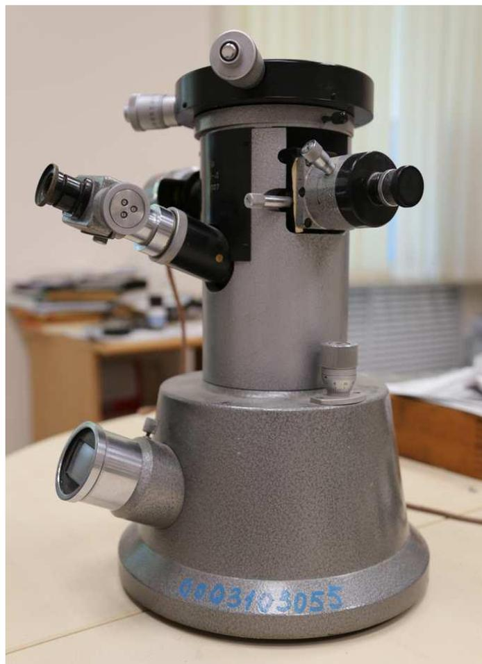
Рисунок 2.8 – Микроинтерферометр МИИ-4
