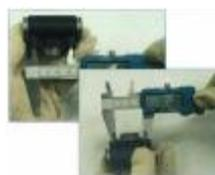
1. Измерения производить штангенциркулем ШЦЦ/ШЦК-1- 150-0,01 ГОСТ 166-89 по дальнележащим и близлежащим точкам внутреннего диаметра метрической резьбы М6-6Н двух отверстий. Определить среднеарифметическое значение суммы измерений. Измерения произвести не менее 3-х раз.
