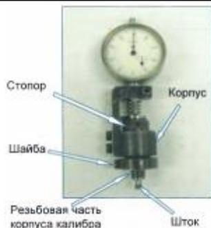
1. Ввернуть резьбовую часть корпуса калибра в резьбовое отверстие М10х1,25-6Н детали до упора шайбы калибра в контролируемую деталь.
