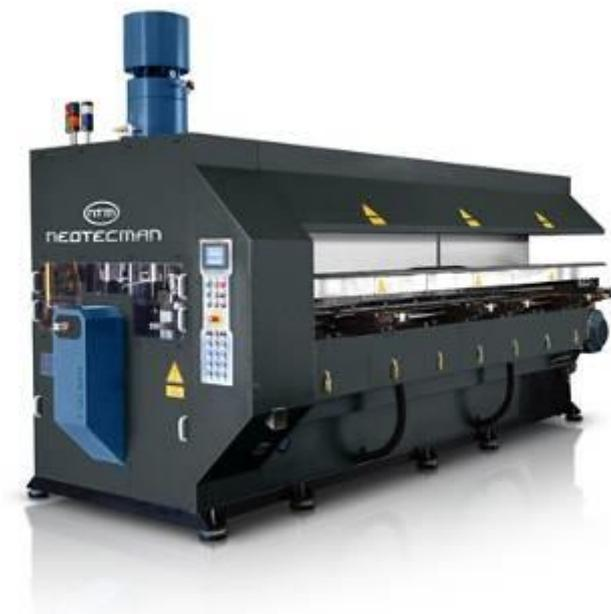
Рисунок 2.1.4 - Станок для горячей безоблойной штамповки
