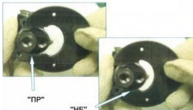
1. Установить скобу на поверхность установочного выступа детали. Проходной размер скобы «ПР» должен проходить, непроходной «НЕ» - не проходить.
