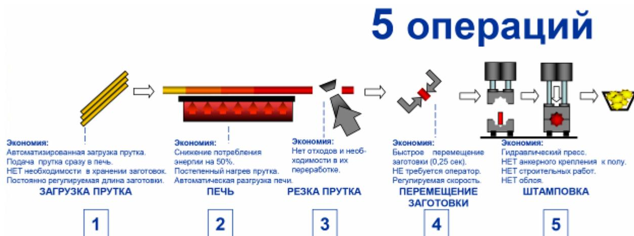
Рис.2.1.5 - Предлагаемый технологический процесс
