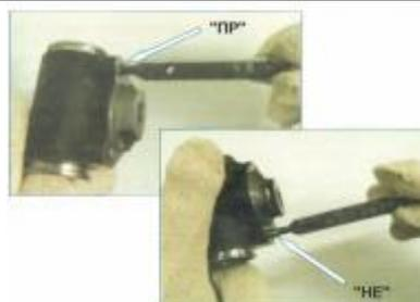
1. Ввернуть в резьбовое отверстие пробку. Резьба считается годной, если проходная сторона (ПР) резьбового калибра свинчивается с изделием по всей длине нарезки без усилия. Непроходная сторона (НЕ) калибра должна свинчиваться с изделием не более, чем на 1-2 нитки.
