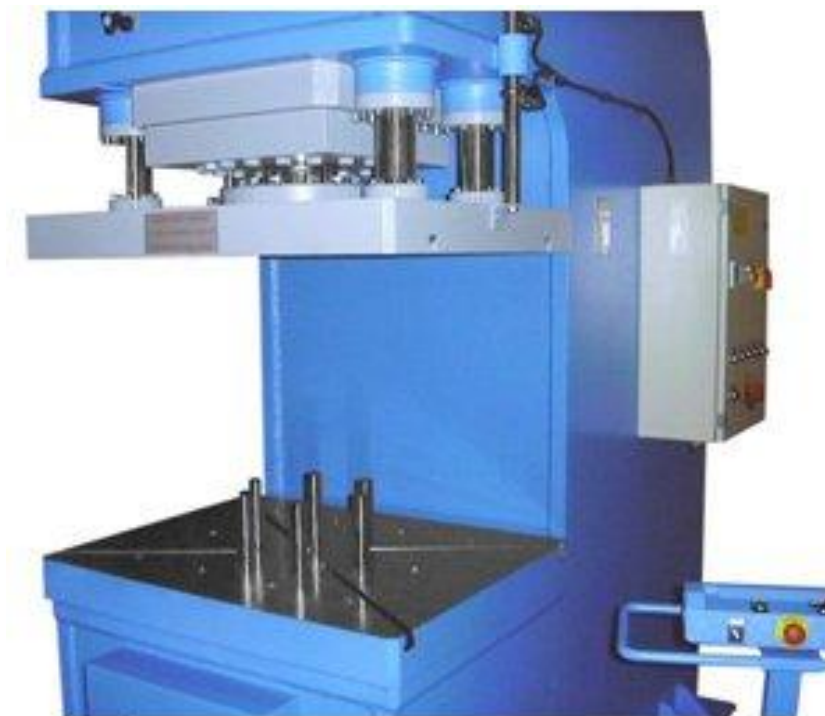
Рисунок 3.7 – Выталкиватели в нижней части прессы [25]
