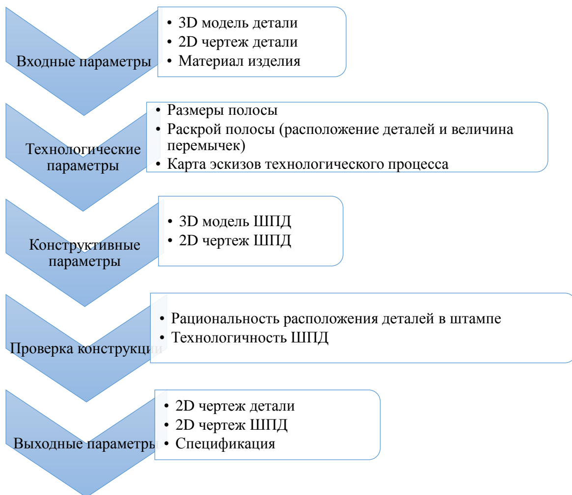
Рисунок 2.1 – Последовательность проектирования штамповой оснастки в программном модуле Мастер проектирования ШПД
