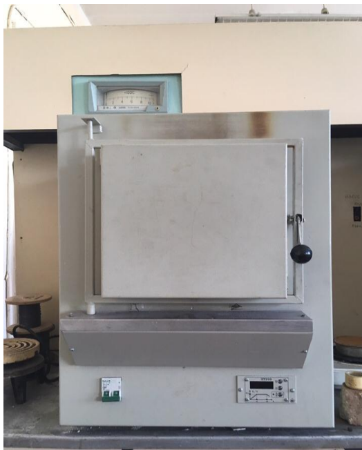
Рисунок 2.11 – Лабораторная электропечь сопротивления СНОЛ 6/1
