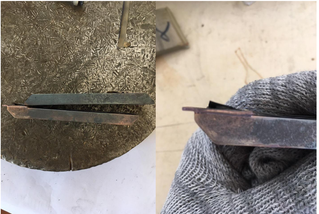
Рисунок 3.15– Результаты пайки без совмещения
