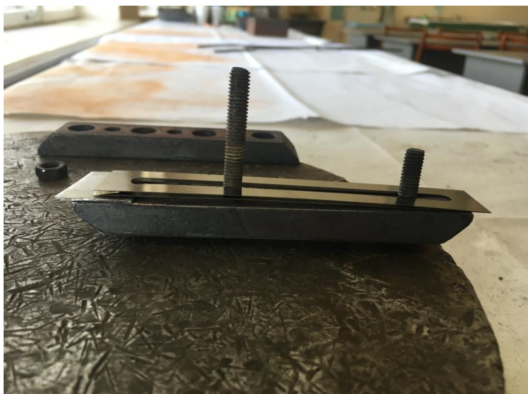
Рисунок 3.6 - Укладка припоя между магнитострикционными пластинами
