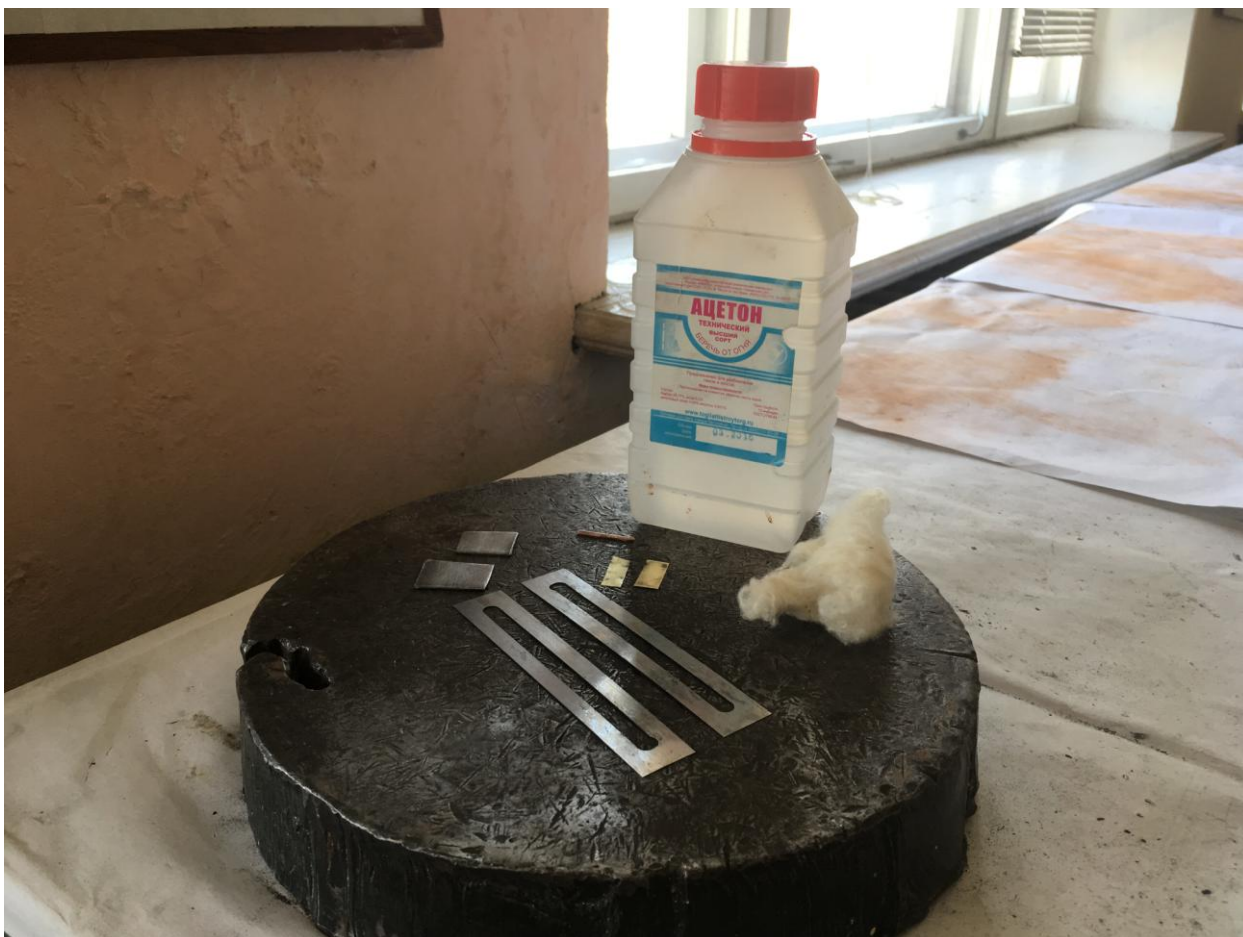
Рисунок 3.4 – Обезжиривание паяемых поверхностей
