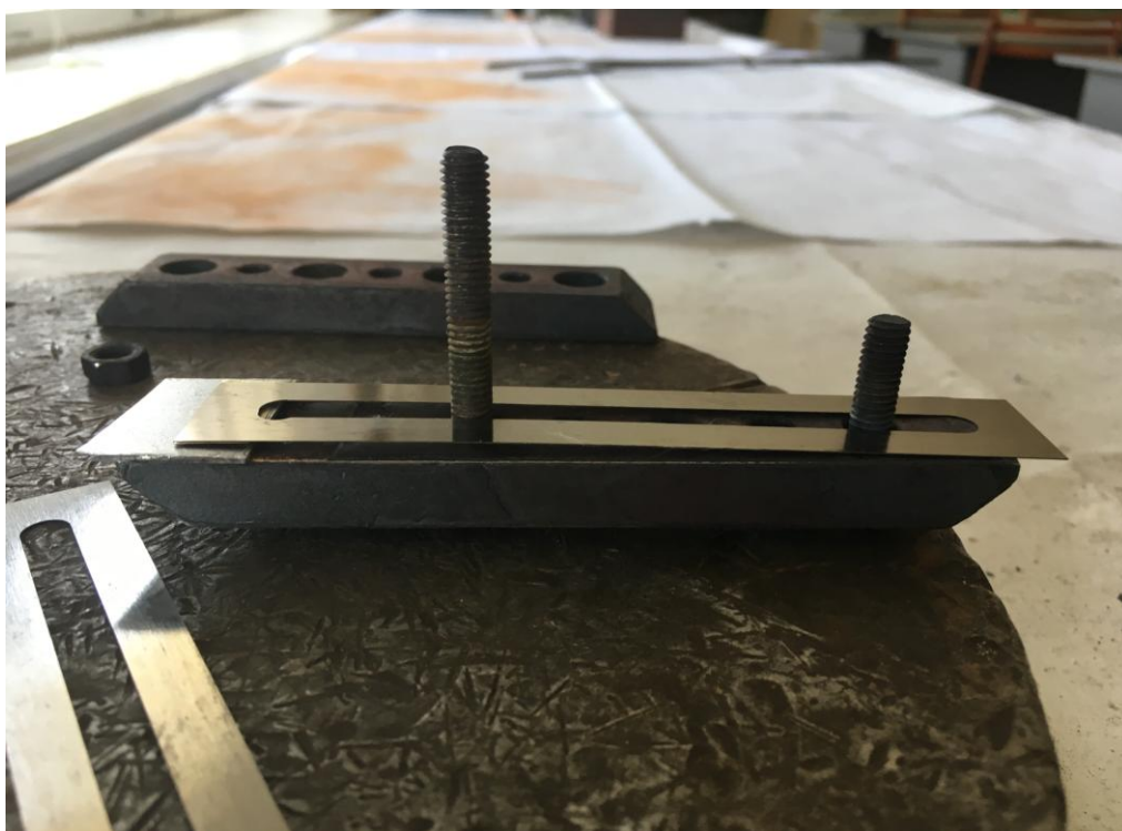
Рисунок 3.5 – Укладка припоя между стальной и магнитострикционной пластиной
