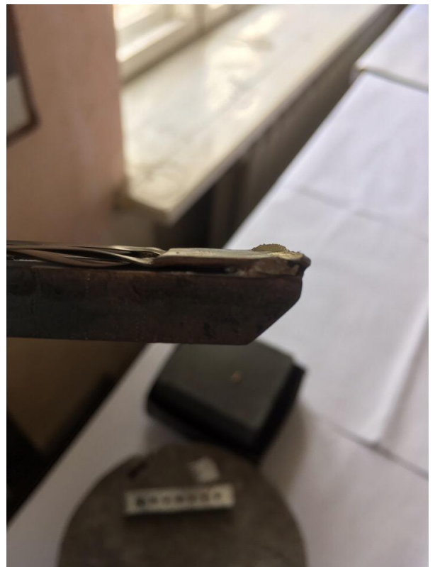
Рисунок 3.17– Результаты пайки с использованием обмазки мелом струбцин
