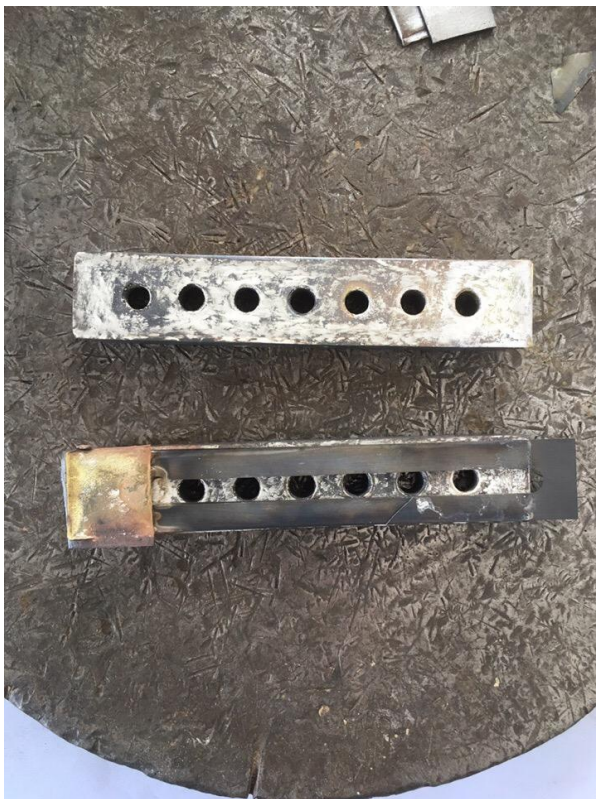
Рисунок 3.17– Результаты пайки с использованием обмазки мелом струбцин
