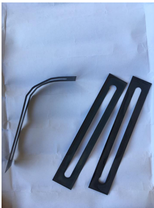
Рисунок 2.28 – Магнитострикционные пластины после скорректированного режима термообработки
