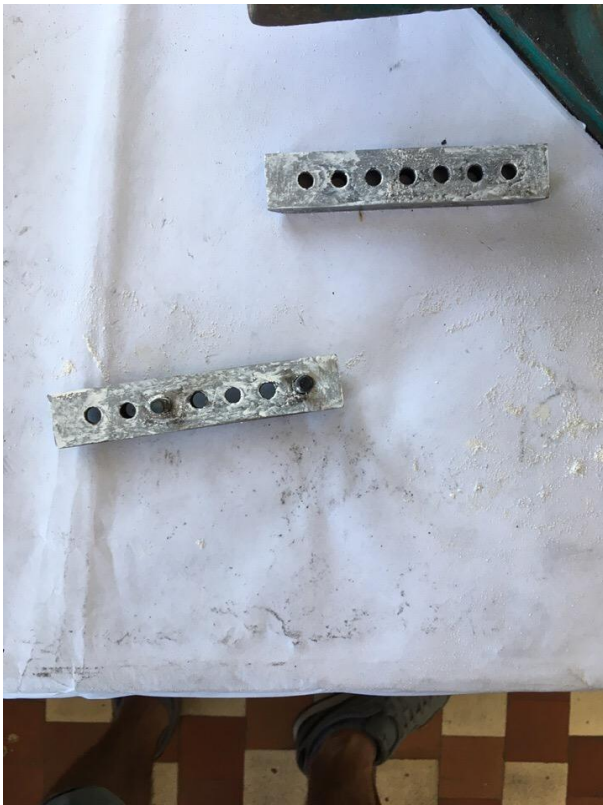
Рисунок 3.16– Пайка с использованием обмазки мелом струбцин
