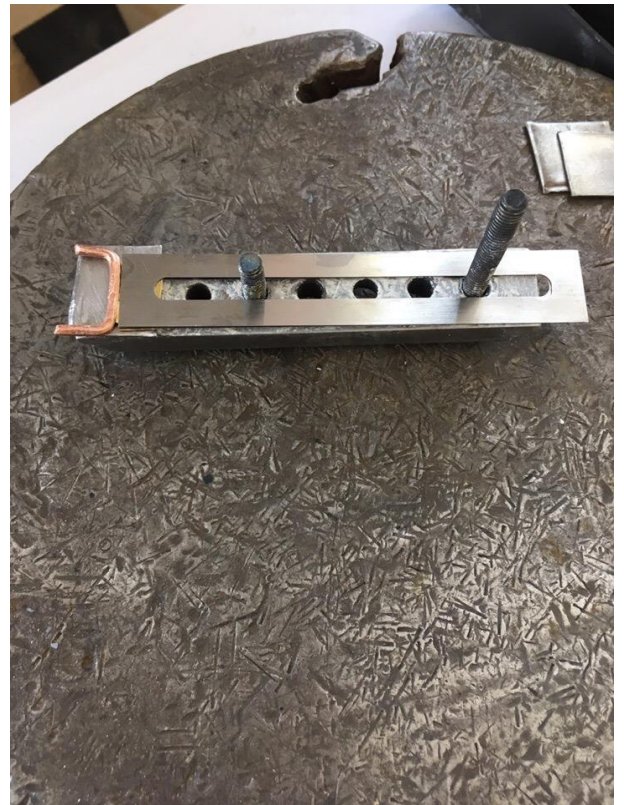
Рисунок 3.16– Пайка с использованием обмазки мелом струбцин
