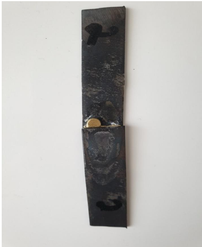
Рисунок 3.7 – Образец из стали с припоем Л-63
