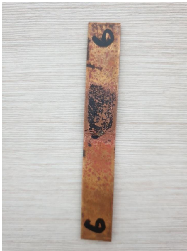
Рисунок 3.14 – Образец из меди с припоем Алармет 211
