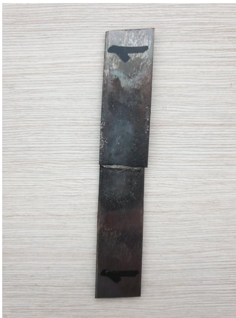
Рисунок 3.11 – Образец из стали с припоем Л63
