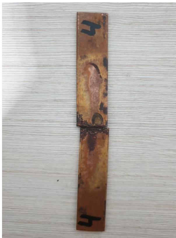
Рисунок 3.16 – Образец из меди с припоем ПСр-45
