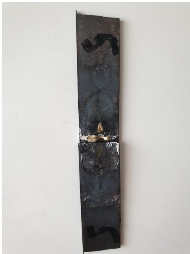
Рисунок 3.5 – Образец из стали с припоем ПСр-45
