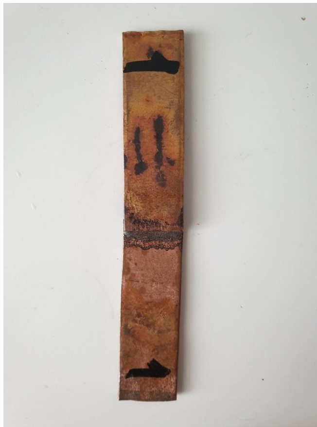
Рисунок 3.3 – Образец из меди с припоем ЛКБО 62-0,2-0,04-0,5
