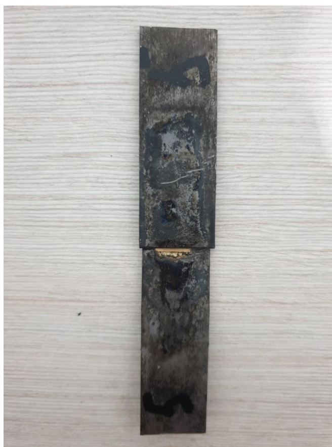
Рисунок 3.15 – Образец из стали с припоем ПСр-45
