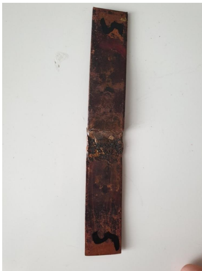
Рисунок 3.6 – Образец из меди с припоем ПСр-45
