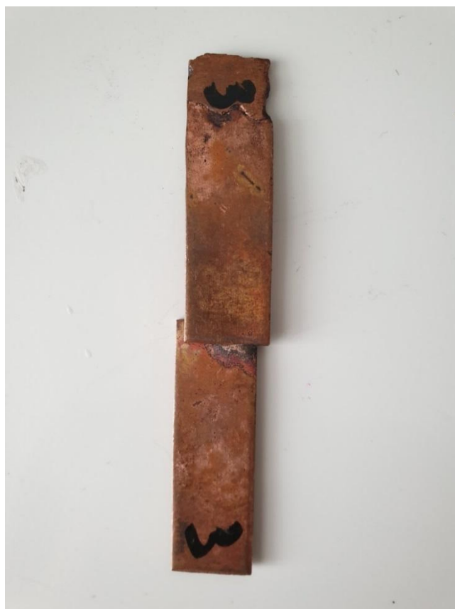
Рисунок 3.10 – Образец из меди с припоем Алармет 211
