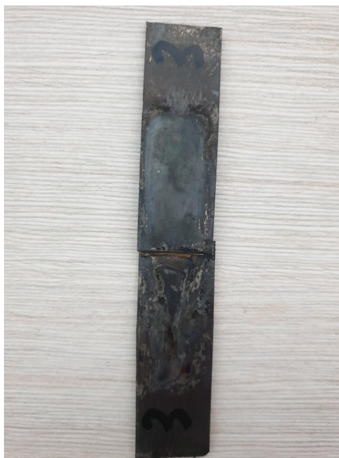
Рисунок 3.13 – Образец из стали с припоем Алармет 211
