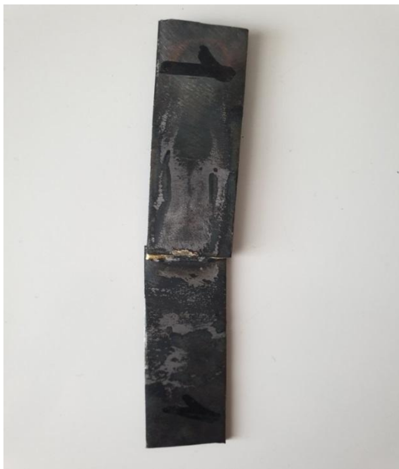
Рисунок 3.1 – Образец из стали с припоем ЛКБО 62-0,2-0,04-0,5
