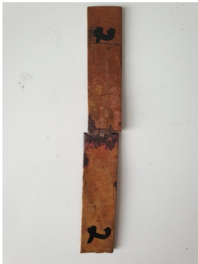
Рисунок 3.8 – Образец из меди с припоем Л 63
