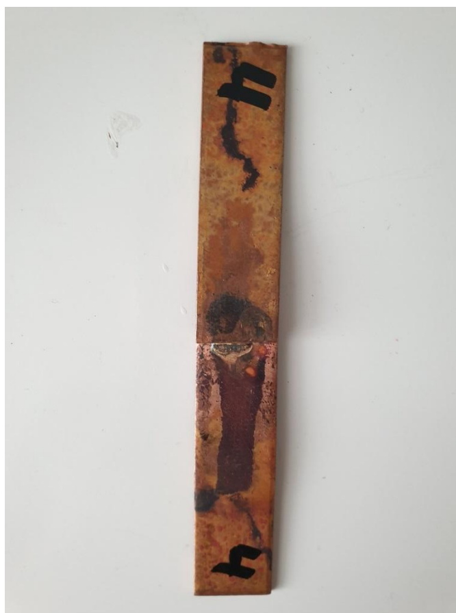
Рисунок 3.4 – Образец из меди с припоем П81
