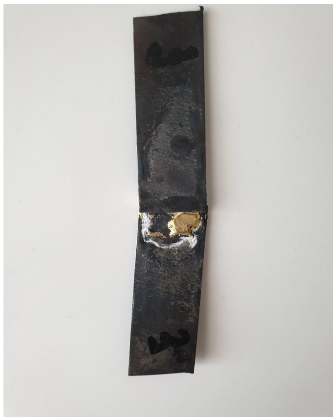
Рисунок 3.9 – Образец из стали с припоем Алармет 211
