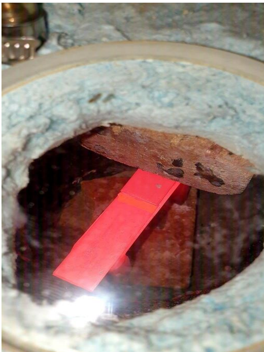
Рисунок 2.8 – Процесс пайки пластин в контролируемой атмосфере
