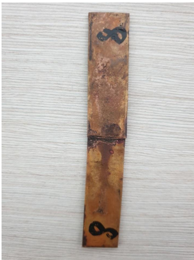
Рисунок 3.12 – Образец из меди с припоем Л63
