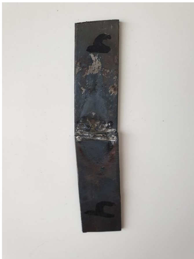
Рисунок 3.2 – Образец из стали с припоем П81
