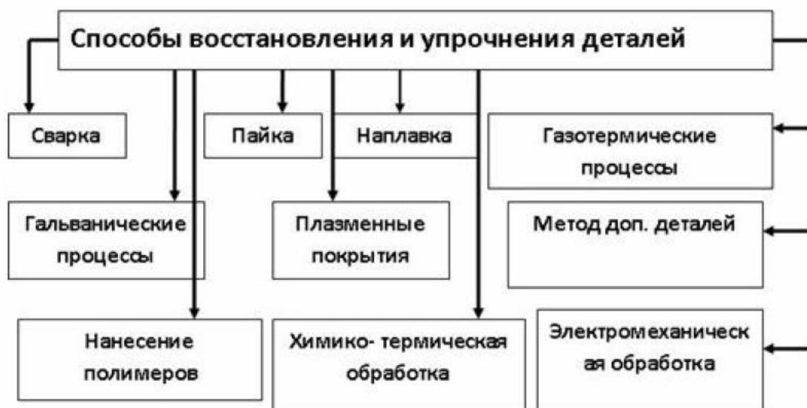
Рисунок 9 - Способы восстановления и упрочнения поверхностей деталей
