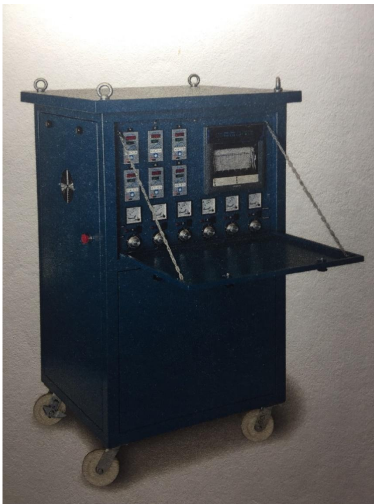
Рисунок 53 - Установка для термообработки модель РТ 75-6.
