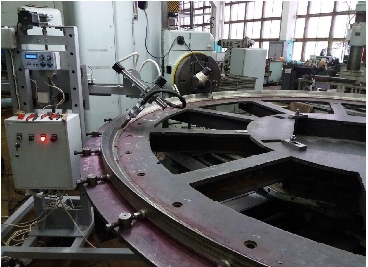
Рисунок 41 – Позиционирование уплотнительного кольца на оснастке
