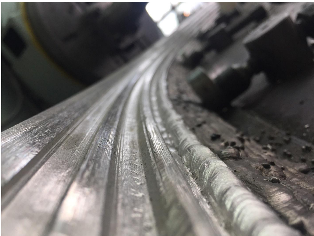
Рисунок 46 – Наплавленная поверхность после токарной обработки
