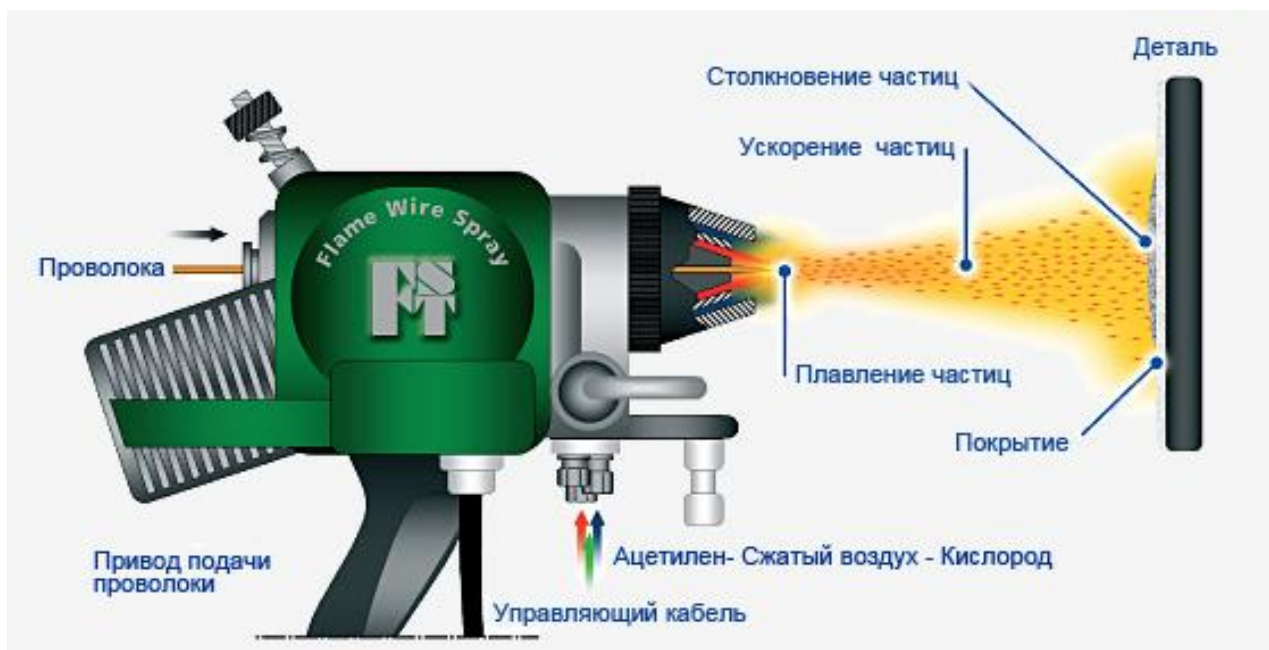
Рисунок 17 - Схема процесса газопламенного напыления
