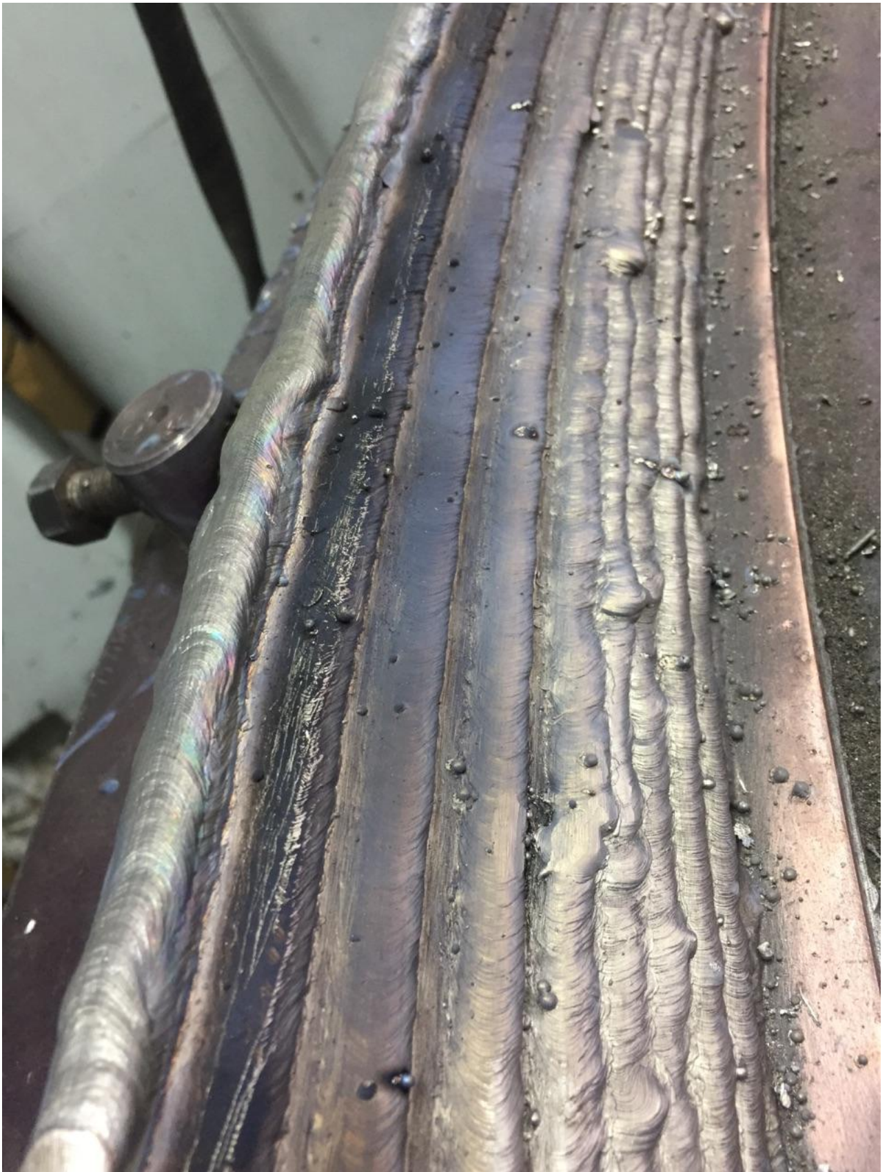
Рисунок 45 – Наплавленная поверхность верхней части кольца
