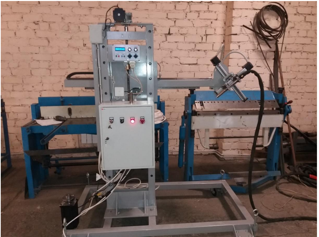
Рисунок 26 – Установка для автоматической наплавки
