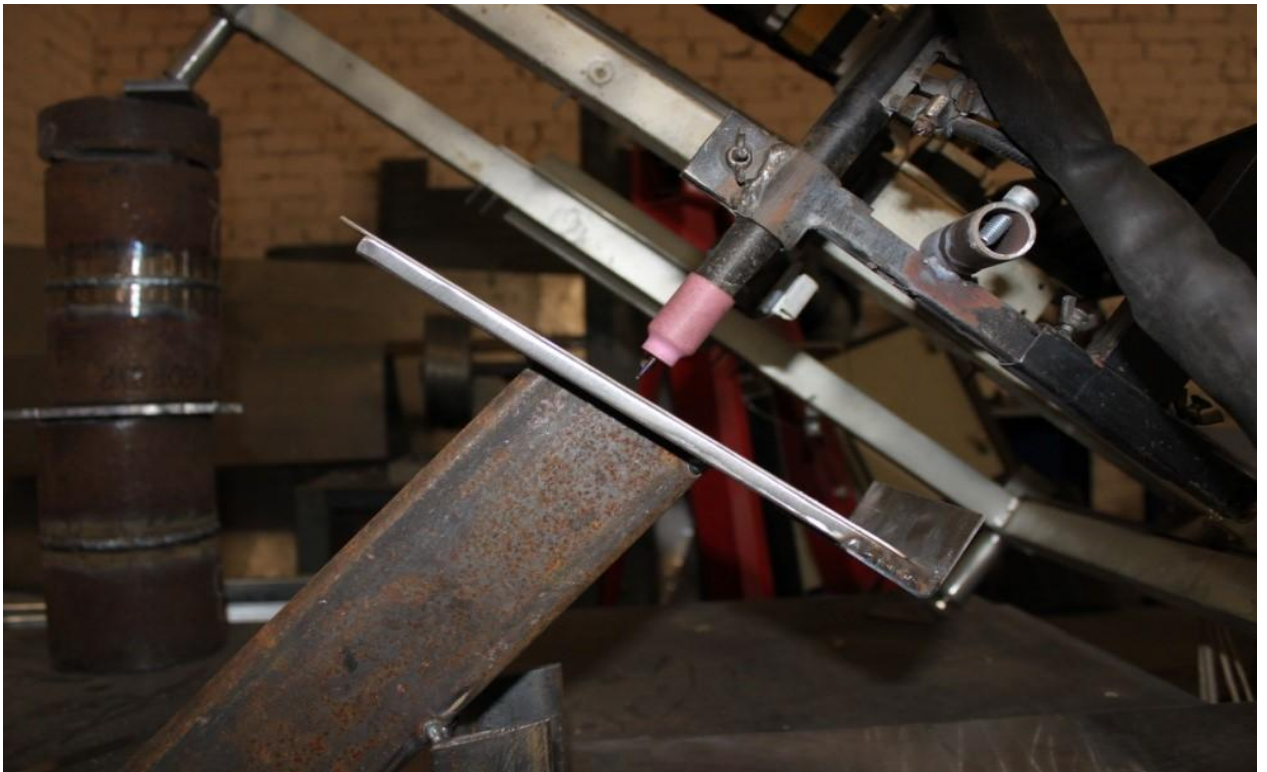
Рисунок 19 – Позиционирование сварочной горелки
