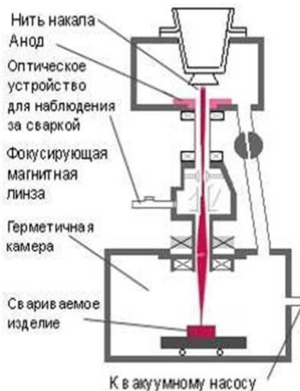
Рисунок 14 - Схема работы электронно-лучевой наплавки
