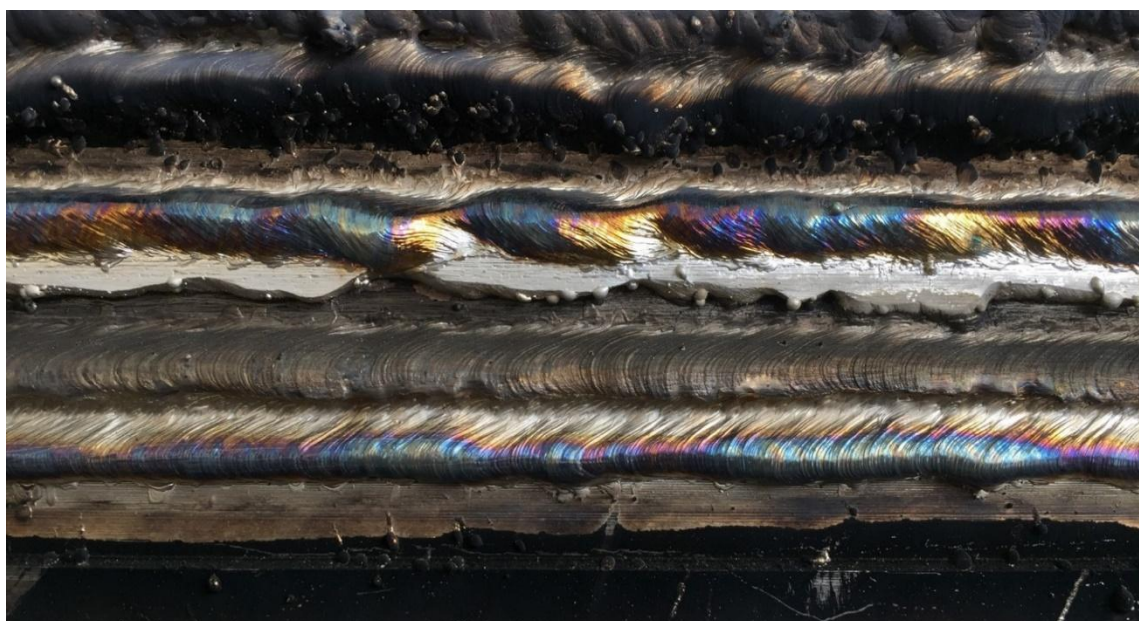
Рисунок 48 – Наплавленная поверхность внешней стороны кольца
