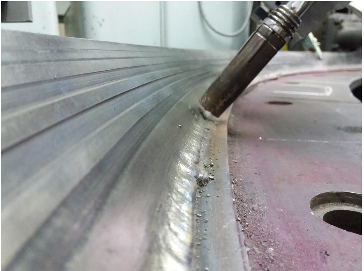
Рисунок 43 – Позиционирование сварочной горелки
