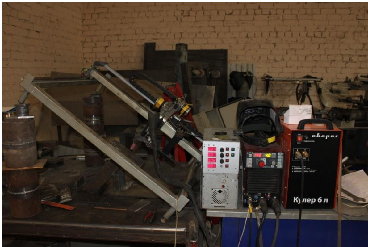
Рисунок 18 – Установка для аргонодуговой наплавки неплавящимся электродом
