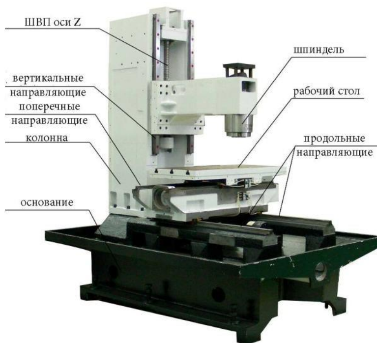
Рисунок 1.3 – Основные узлы станков с ЧПУ по металлу
