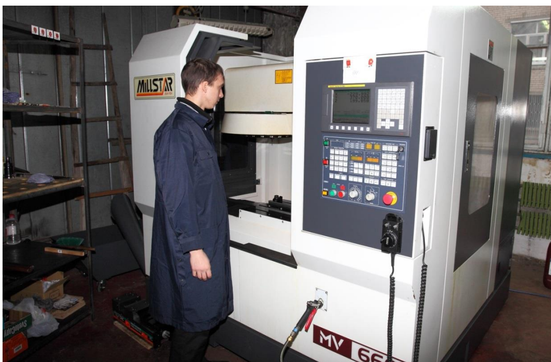
Рисунок 1.5 – Общий вид фрезерного станка для обработки сложноконтурных изделий в условиях единичного производства
