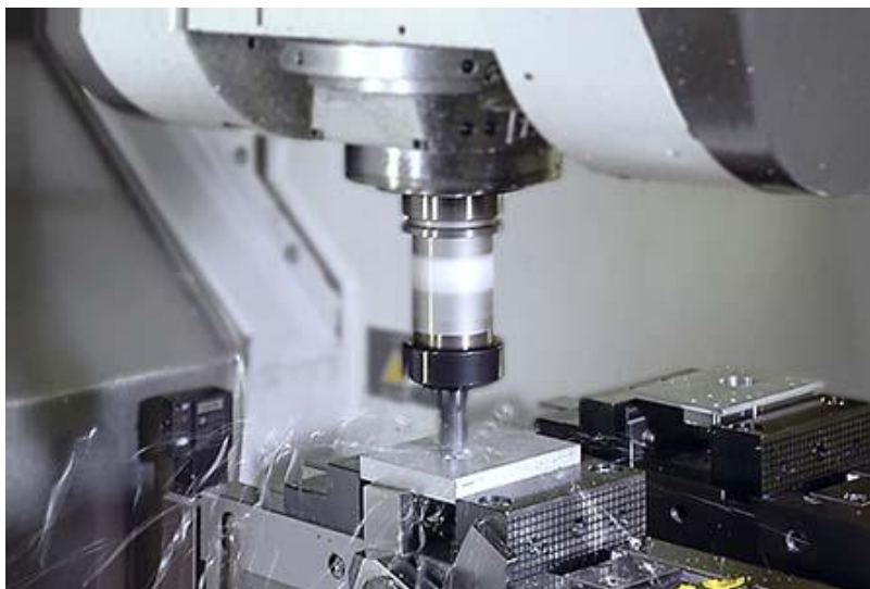
Рисунок 1.2 – Типовой вид обработки по программе ЧПУ с применением вертикально – фрезерного станка
