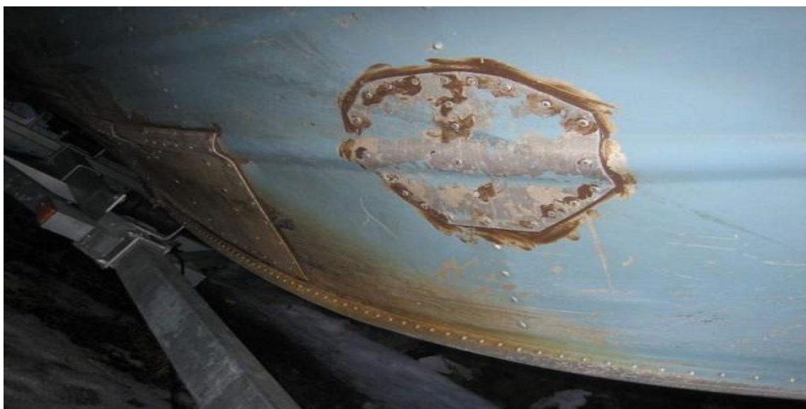
Рисунок 2.1 - Установка заплата при помощи клепки.
