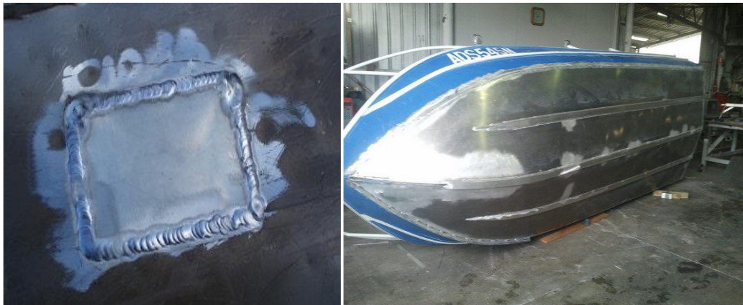
Рисунок 2.2 - Установка заплатки при помощи сварки.
