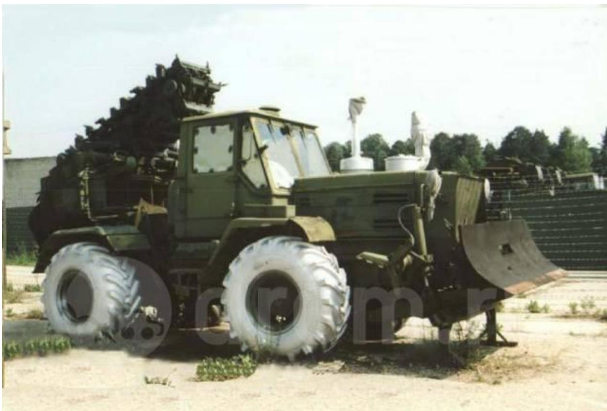
Рисунок 1.1 – Цепной траншейный экскаватор
