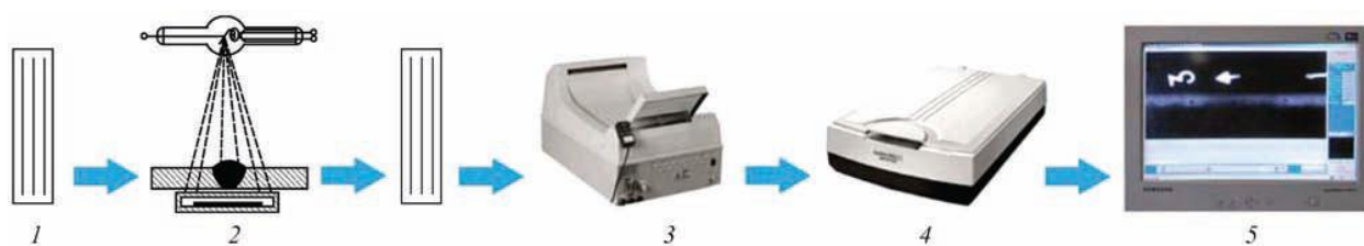
Рисунок 2.10 – Традиционная схема радиографического контроля с использованием пленки и оцифровки рентгенограмм: зарядка кассет (1); просвечивание на рентгеновскую пленку (2); процедура обработки пленки (3); сканирование пленки (4); ЦИ (5)
