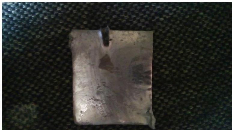
Рисунок 25 – Внешний вид образца после применения флюса №6
