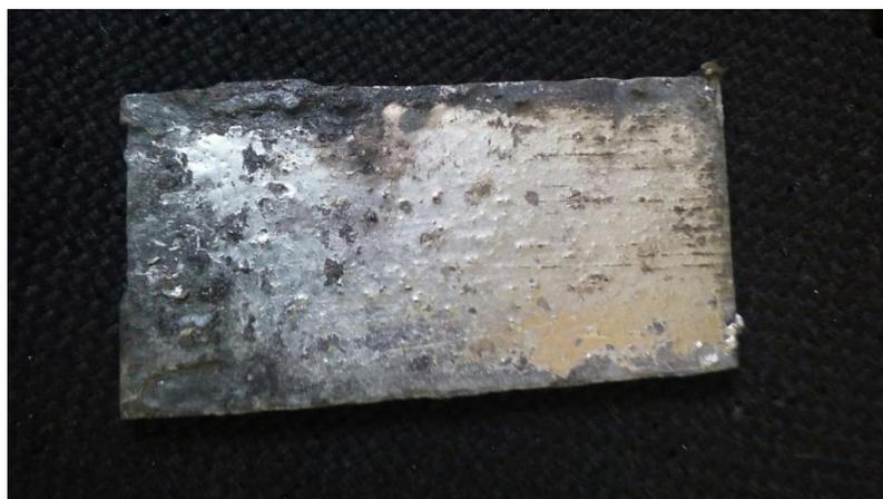
Рисунок 27 – Внешний вид образца после погружения в эвтектический расплав олово-свинец
