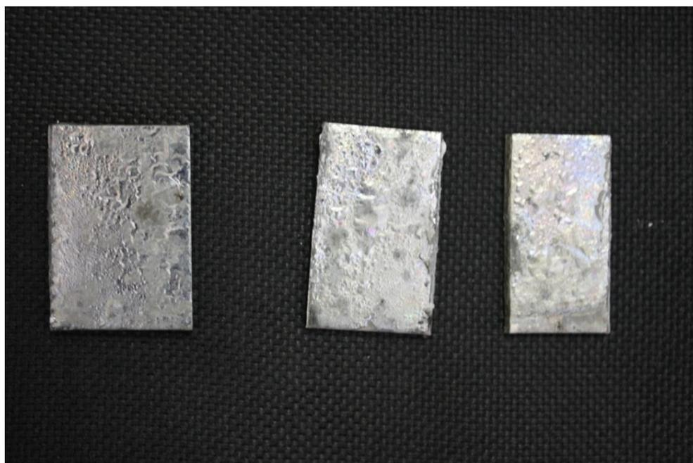
Рисунок 19 – Алюминиевые образцы покрытые никелем и свинцом
