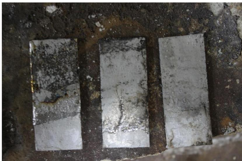
Рисунок 21 – Результат применения флюса системы  $\text{CaCl}_2 - \text{NaCl}$
