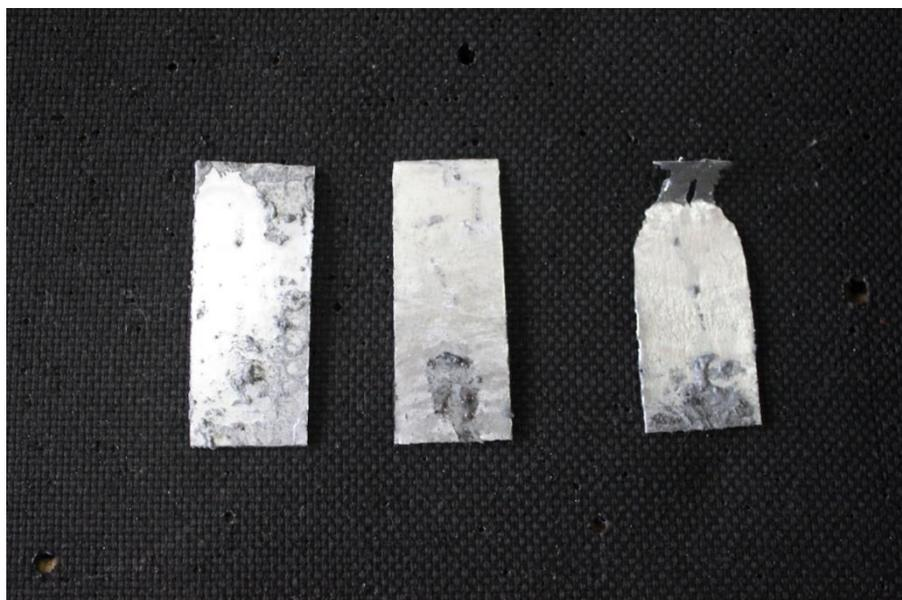
Рисунок 23 – Внешний вид образцов после применения флюса №3
