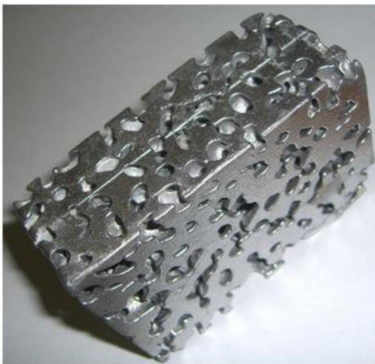
Рисунок 6 – Блок из пеноалюминия
