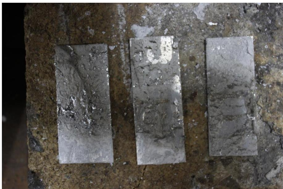
Рисунок 22 – Внешний вид образцов после применения флюса №2
