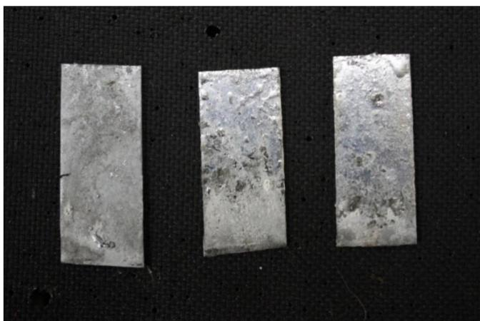
Рисунок 26 – Внешний вид образцов после погружения в свинец и свинцовый баббит
