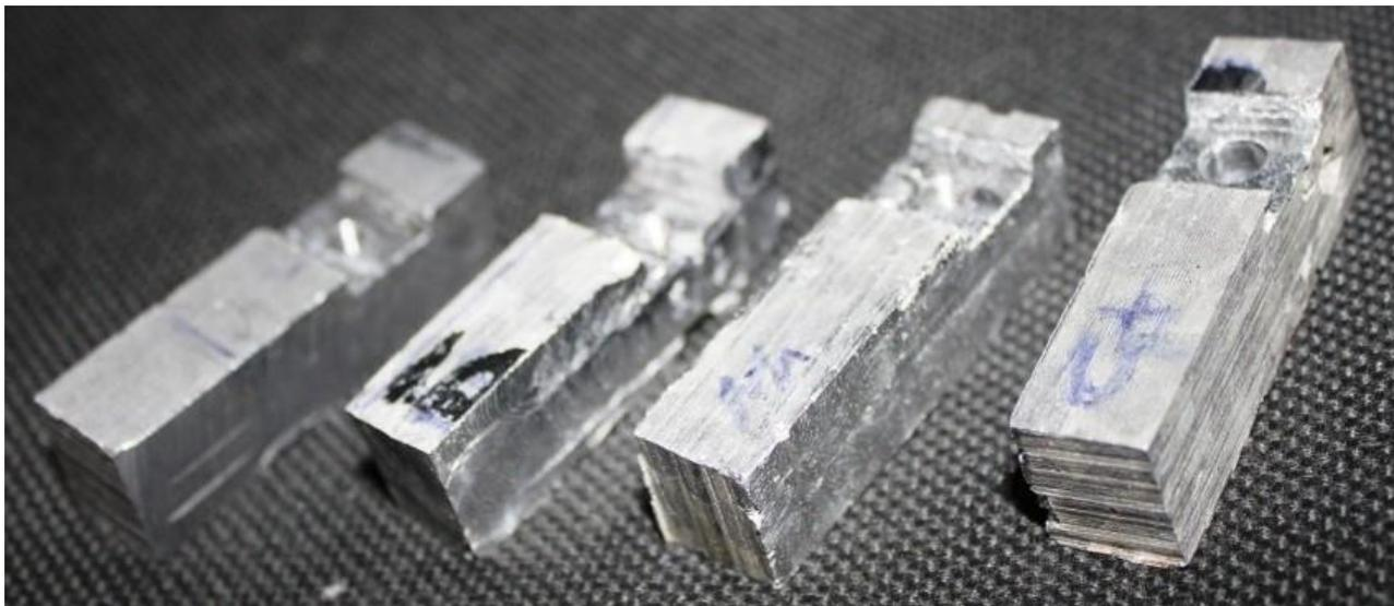
Рисунок 11 – Образцы для испытания износостойкости композиционного материала и баббита Б16
