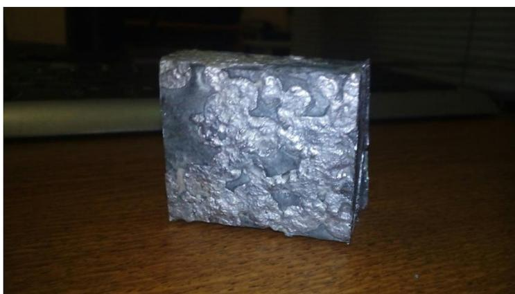
Рисунок 29 – Внешний вид образца, пропитанного эвтектическим расплавом олово-свинец
