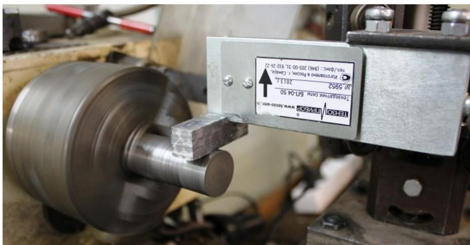
Рисунок 13 – Установка для испытания износостойкости образцов композиционного материала
