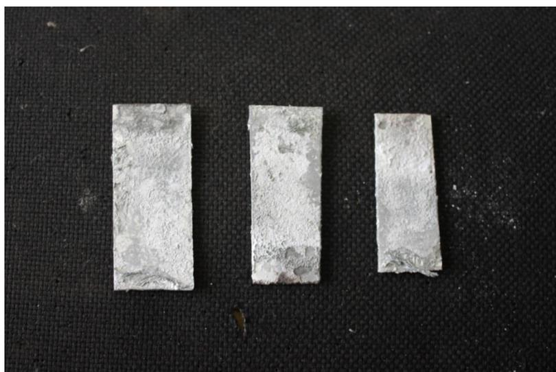
Рисунок 24 – Внешний вид образцов после применения флюса №4
