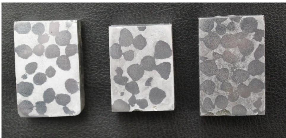
Рисунок 10 – Образцы для определения коэффициента трения скольжения
